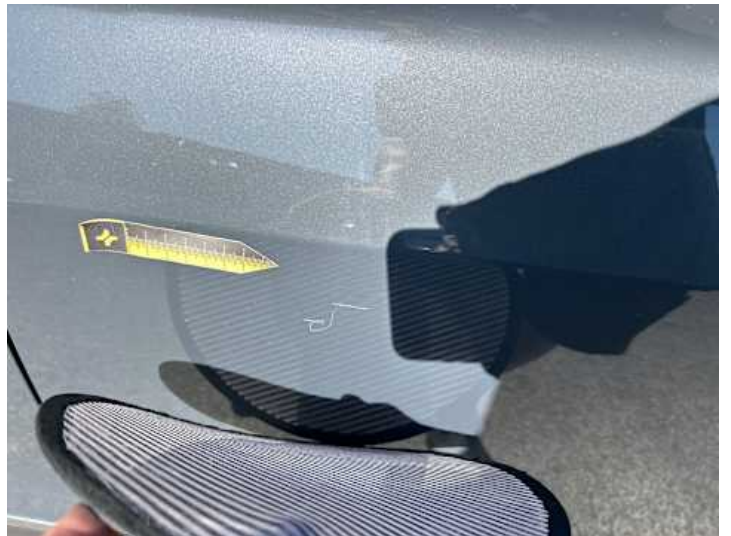
Türe hinten links (Delle, Kratzer)
