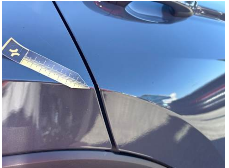
Türe hinten rechts (Kratzer)
