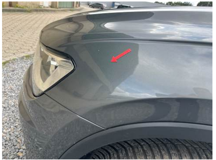
Kotflügel vorne links (Unsachgemäß instand gesetzt, Spaltmaße ungenau)
