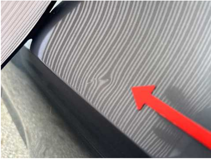
Seitenteil hinten links (Delle, Kratzer)
