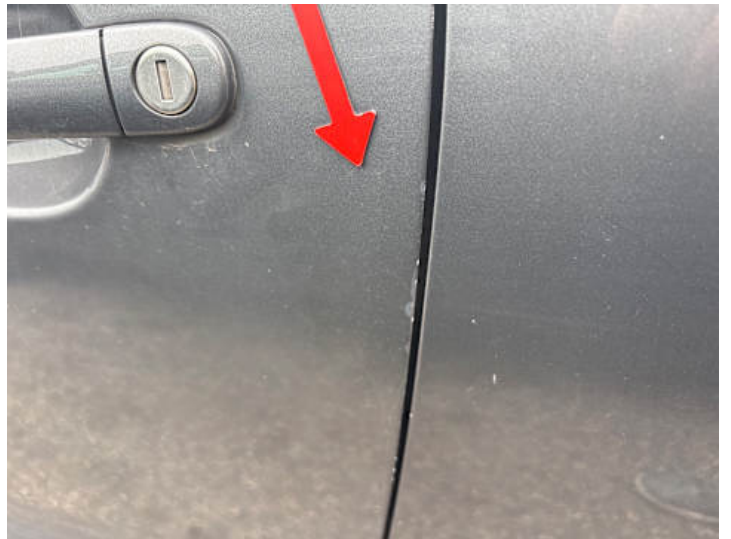
Fahrtür (Kratzer, Delle)
