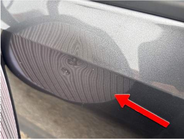
Fahrtür (Kratzer, Delle)
