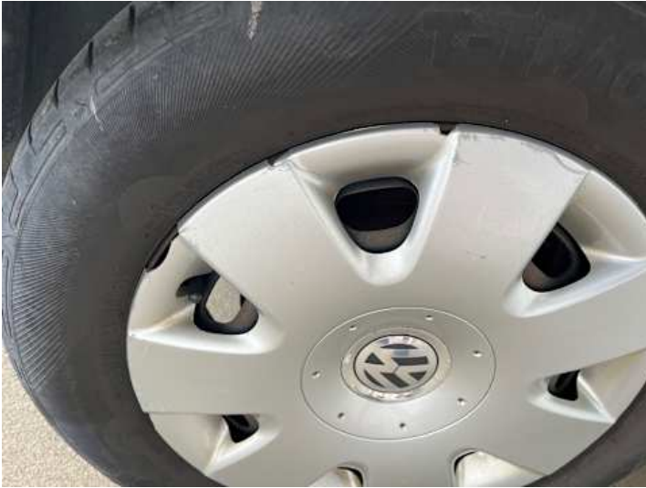
Rad (Riss/Bruch, Kratzer)
