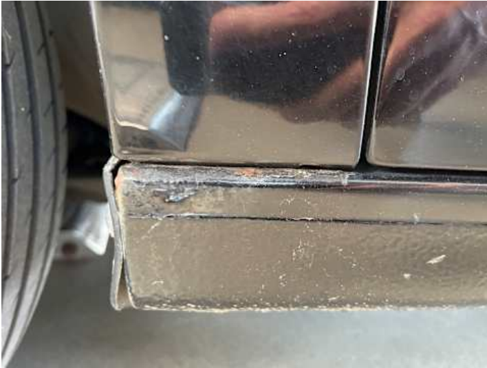
Schweller links (Rost)
