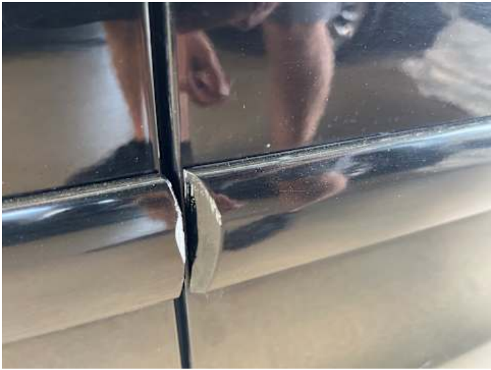
Türe hinten links (Kratzer)
