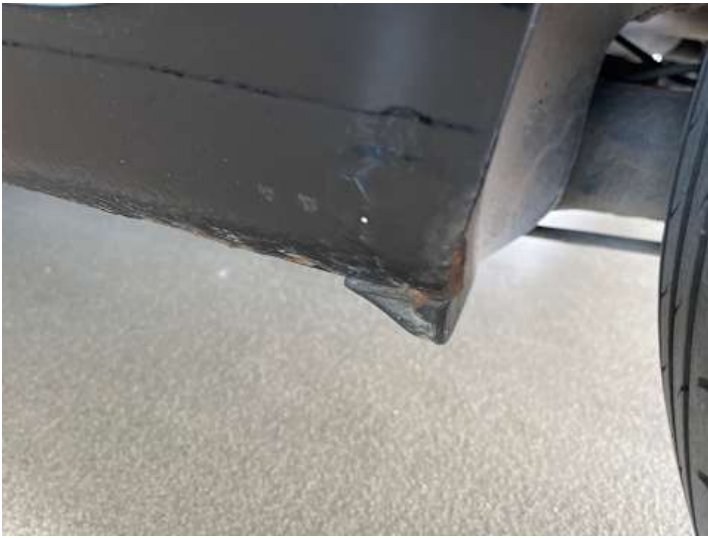
Schweller links (Rost)
