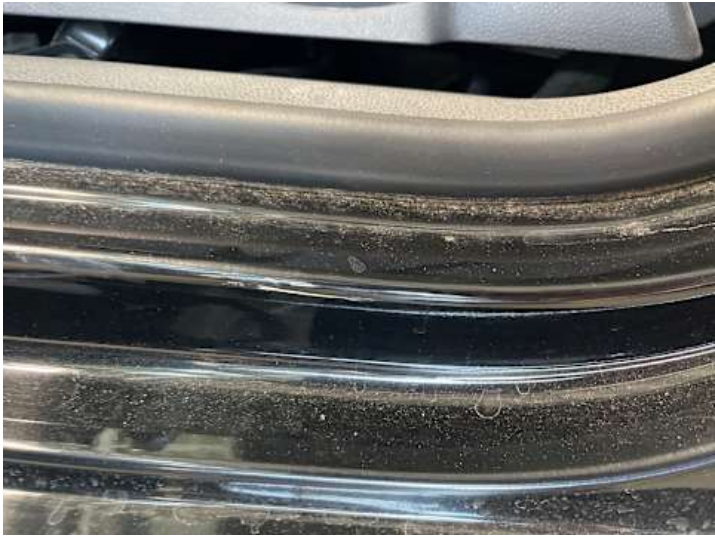
Schweller links (Kratzer)
