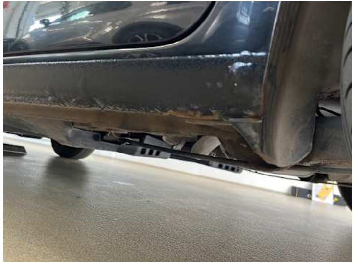
Schweller links (Rost)
