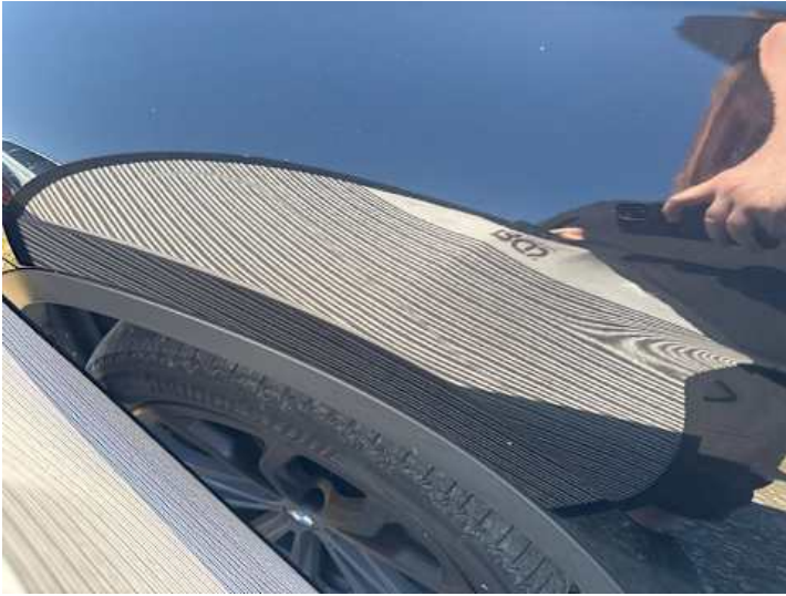
Kotflügel vorne links (Unsachgemäß instand gesetzt)
