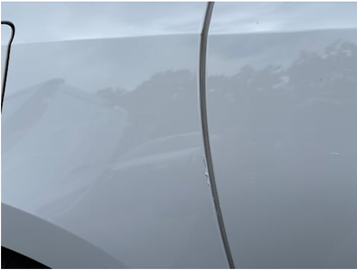
Seitenteil hinten rechts (Kratzer)
