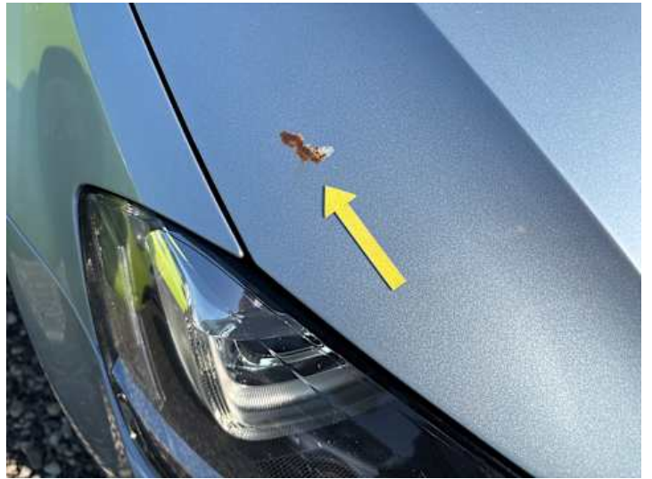
Motorhaube (Lackschaden, Rost)
