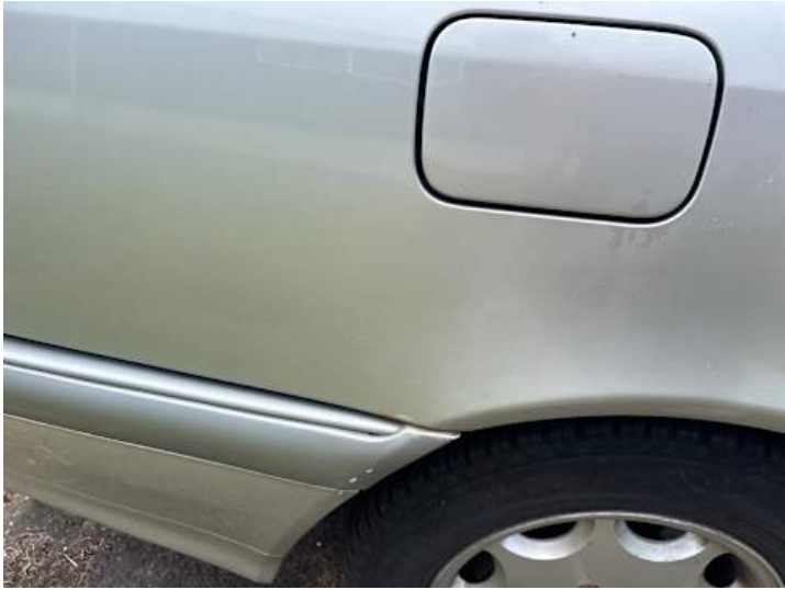
Seitenteil hinten rechts (Lackschaden, Rost)
