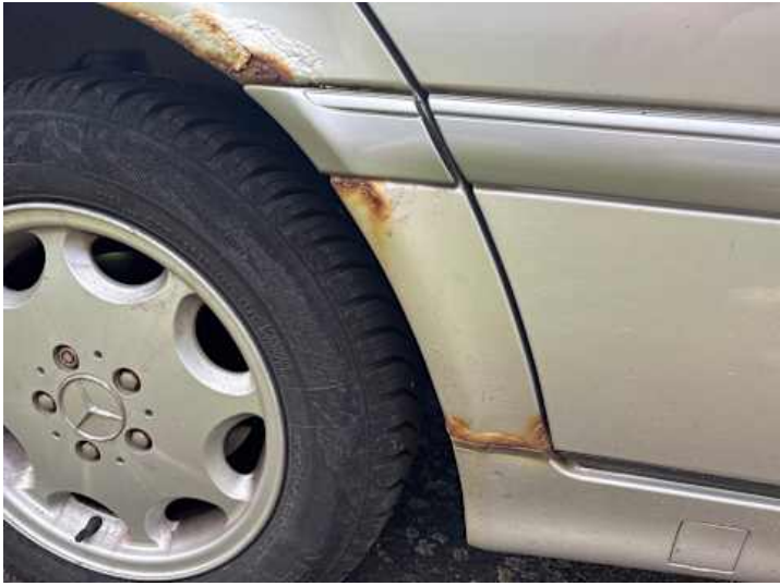
Seitenteil hinten rechts (Lackschaden, Rost)
