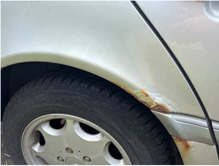
Seitenteil hinten rechts (Lackschaden, Rost)
