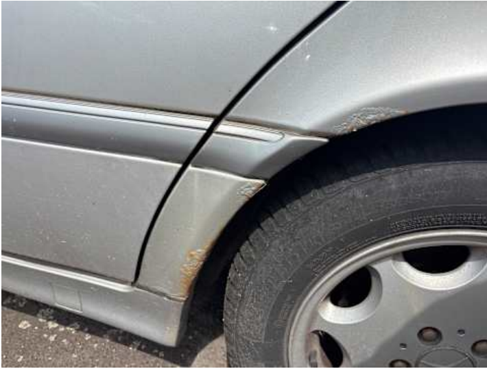
Seitenteil hinten links (Rost, Lackschaden)
