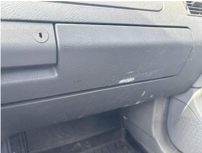
Innenraum (Verschleiß, Kratzer)
