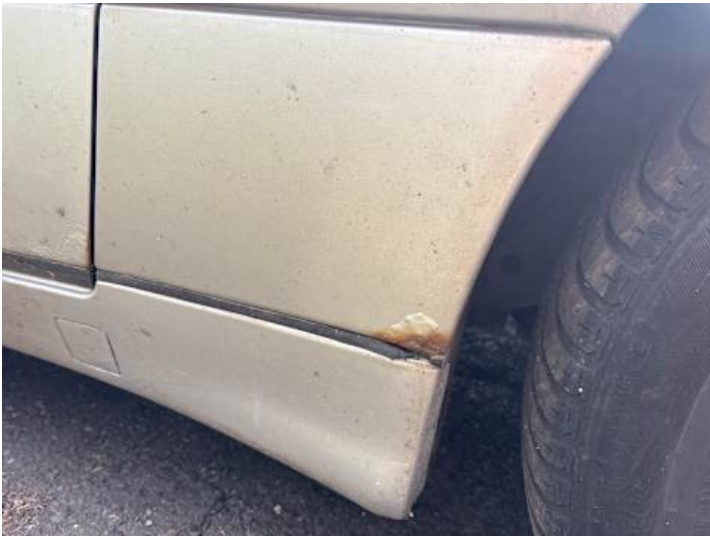
Kotflügel vorne rechts (Rost, Lackschaden)
