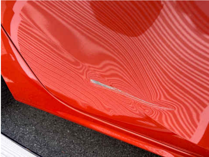
Türe hinten rechts (Verformung, Lackschaden)
