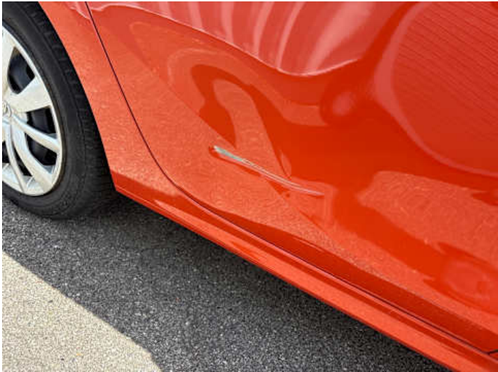
Türe hinten rechts (Verformung, Lackschaden)
