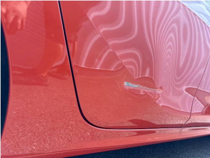
Türe hinten rechts (Verformung, Lackschaden)
