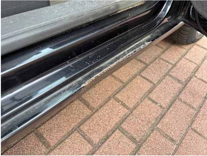
Schweller rechts (Verformung, Lackschaden, Rost)
