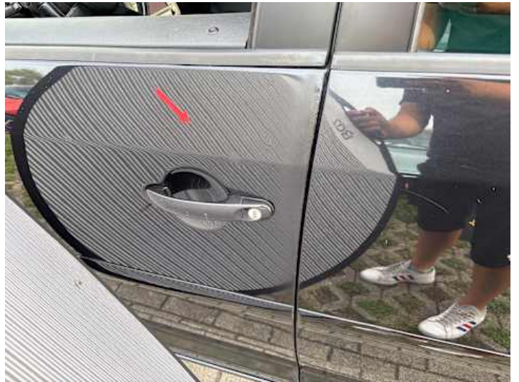
Fahrtür (Unsachgemäß instand gesetzt, Kratzer, Delle)
