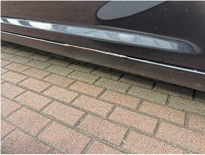
Schweller rechts (Verformung, Lackschaden, Rost)
