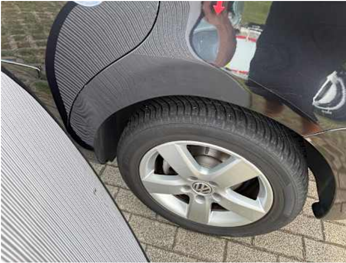
Seitenteil hinten links (Unsachgemäß instand gesetzt, Verformung)
