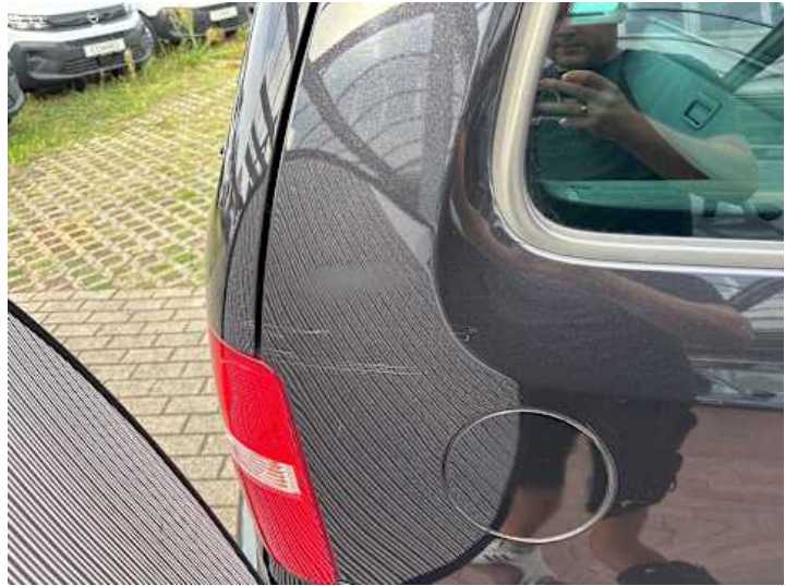
Seitenteil hinten rechts (Verformung, Lackschaden)
