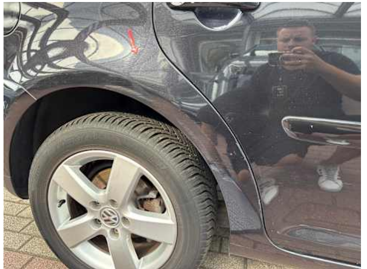
Seitenteil hinten rechts (Verformung, Lackschaden)
