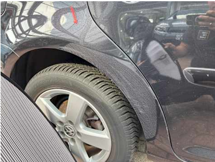
Seitenteil hinten rechts (Verformung, Lackschaden)
