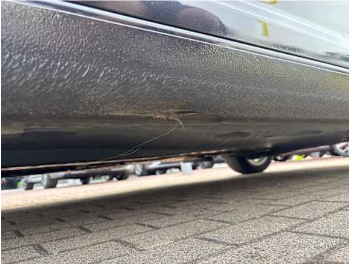
Schweller links (Verformung)
