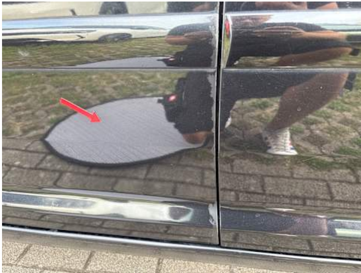
Fahrtür (Unsachgemäß instand gesetzt, Kratzer, Delle)
