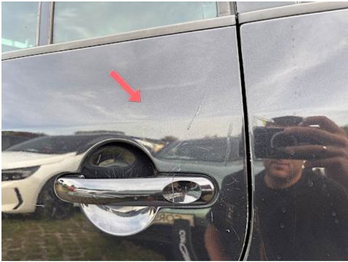
Türe hinten links (Kratzer)
