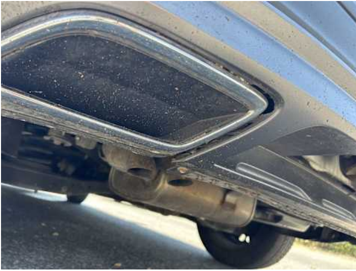
Stoßstange hinten (Unsachgemäß instand gesetzt)
