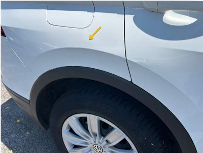
Seitenteil hinten rechts (Unsachgemäß instand gesetzt)
