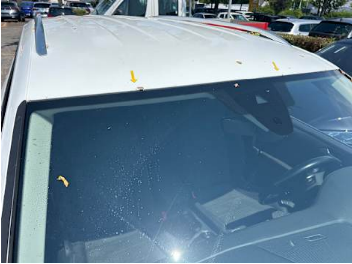
Dach (Steinschlag, Rost)
