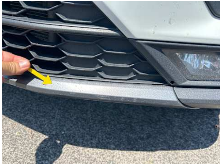
Stoßstange vorne (Kratzer, Spaltmaße ungenau)
