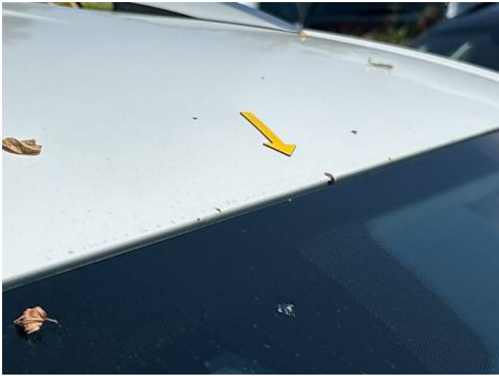
Dach (Steinschlag, Rost)
