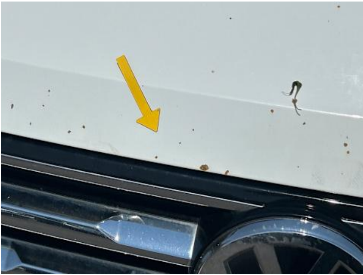
Motorhaube (Steinschlag, Rost)
