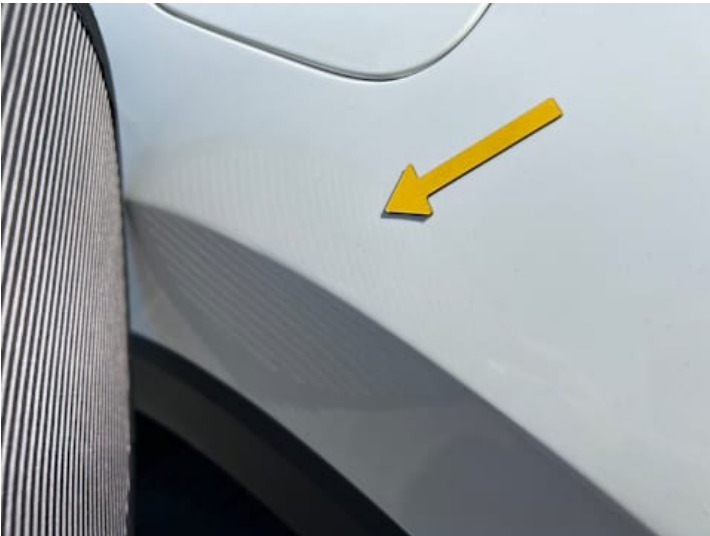
Seitenteil hinten rechts (Unsachgemäß instand gesetzt)
