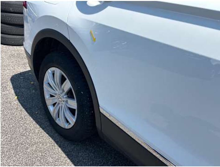
Türe hinten rechts (Delle)
