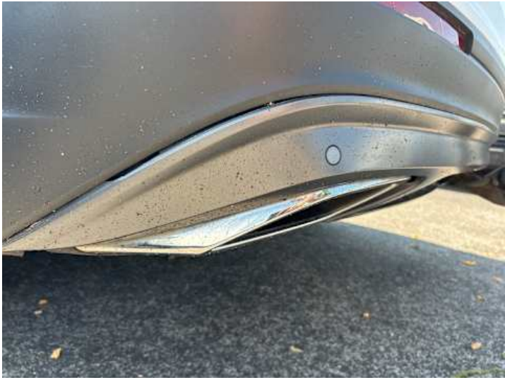
Stoßstange hinten (Unsachgemäß instand gesetzt)
