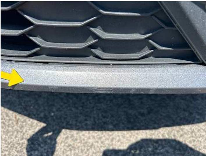
Stoßstange vorne (Kratzer, Spaltmaße ungenau)
