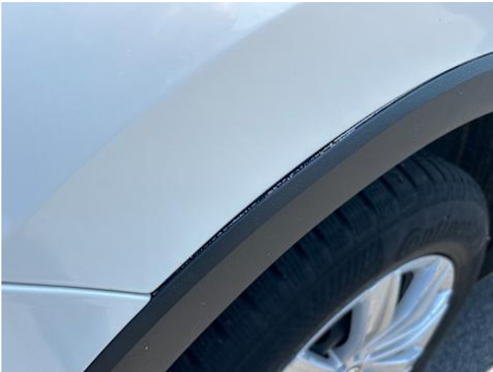
Seitenteil hinten rechts (Unsachgemäß instand gesetzt)
