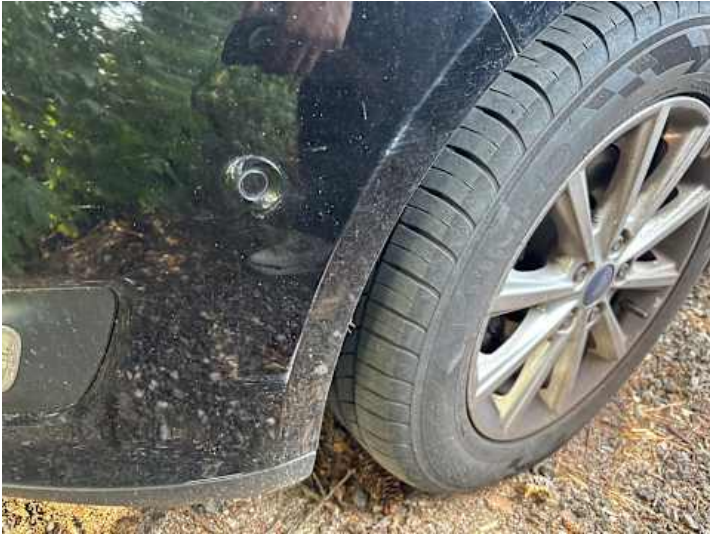
Stoßstange vorne (Lackschaden, Kratzer)
