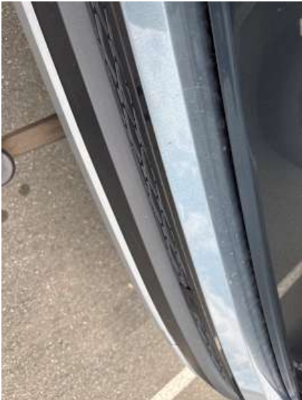
Stoßstange hinten (Kratzer)
