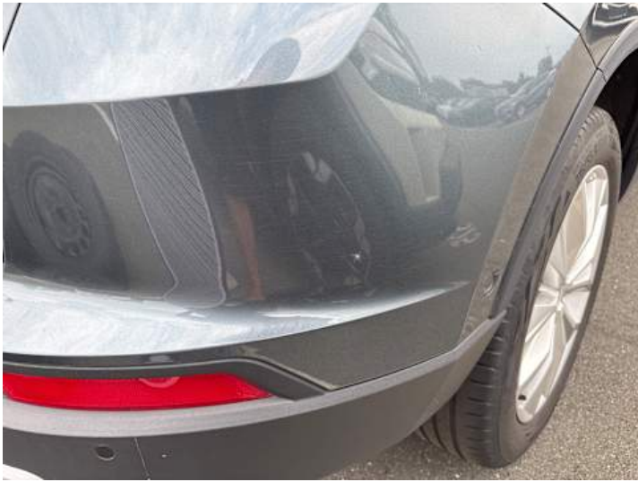
Stoßstange hinten (Kratzer)
