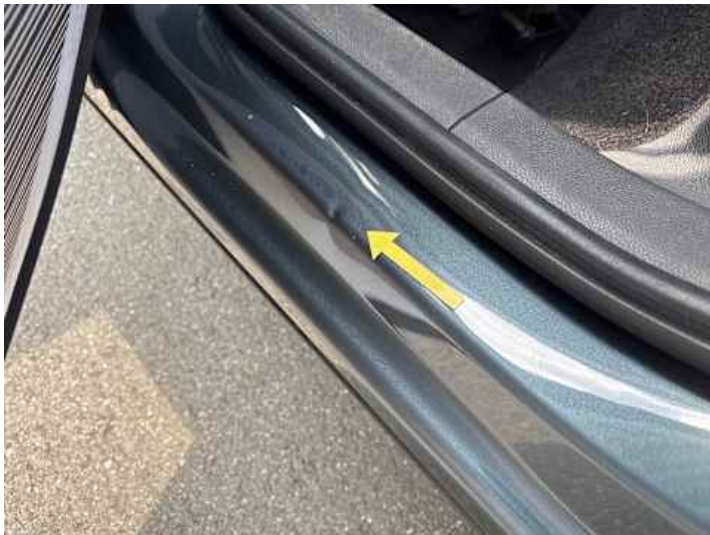
Türe hinten links (Delle)
