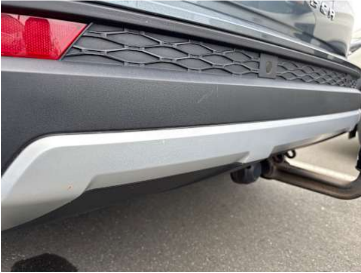
Stoßstange hinten (Kratzer)
