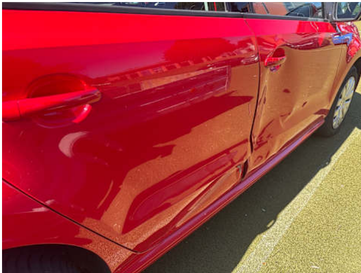
Türe hinten rechts (Lackschaden, Verformung)
