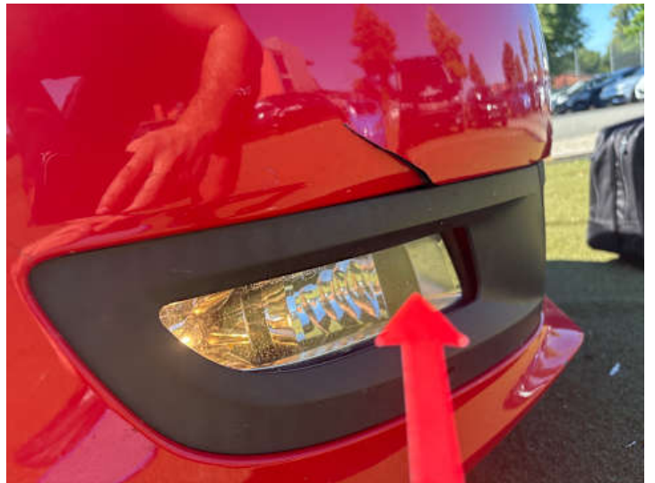
Stoßstange vorne (Riss/Bruch)
