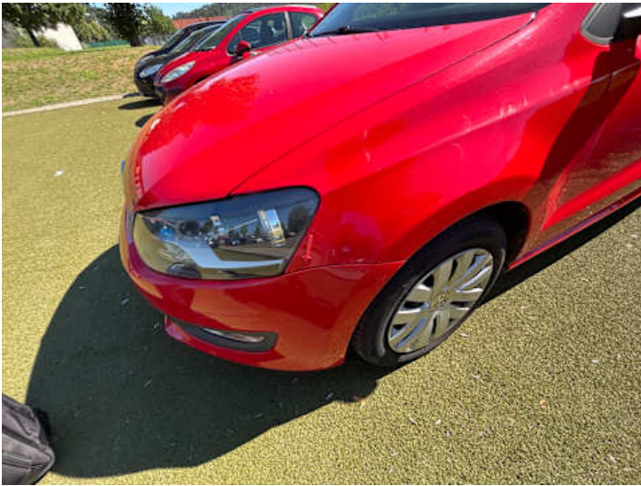
Stoßstange vorne (Spaltmaße ungenau)
