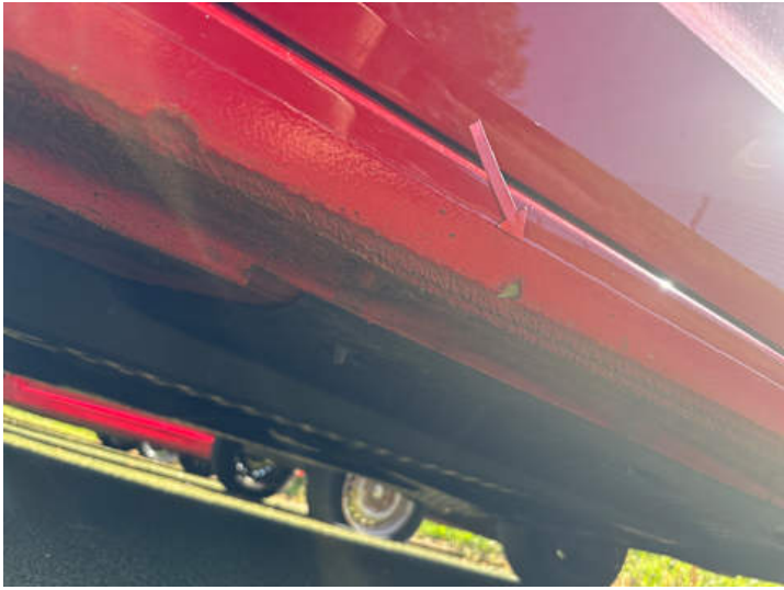
Schweller links (Lackschaden, Verformung)
