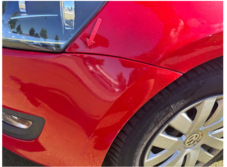
Stoßstange vorne (Spaltmaße ungenau)
