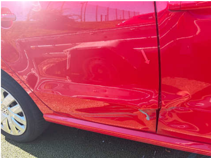
Türe hinten rechts (Lackschaden, Verformung)
