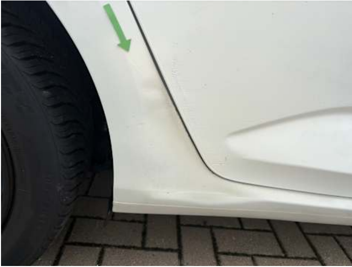
Seitenteil hinten rechts (Verformung, Unsachgemäß instand gesetzt, Lackschaden, Kratzer)
