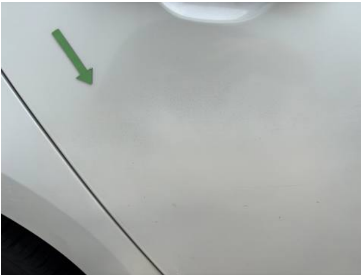
Türe hinten rechts (Lackschaden, Unsachgemäß instand gesetzt)
