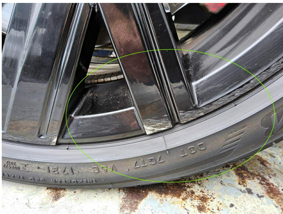
Bild 28 : Felge vorne rechts verschrammt
