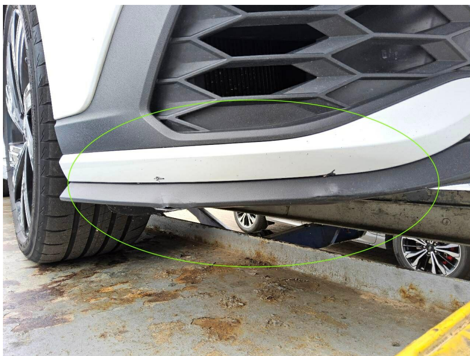
Bild 16 : Stoßfänger vorne rechts verschrammt und Frontspoiler gebrochen
