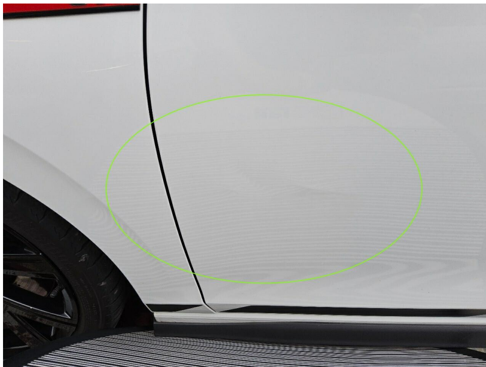
Bild 21 : Tür vorne links eingedrückt und gestaucht
