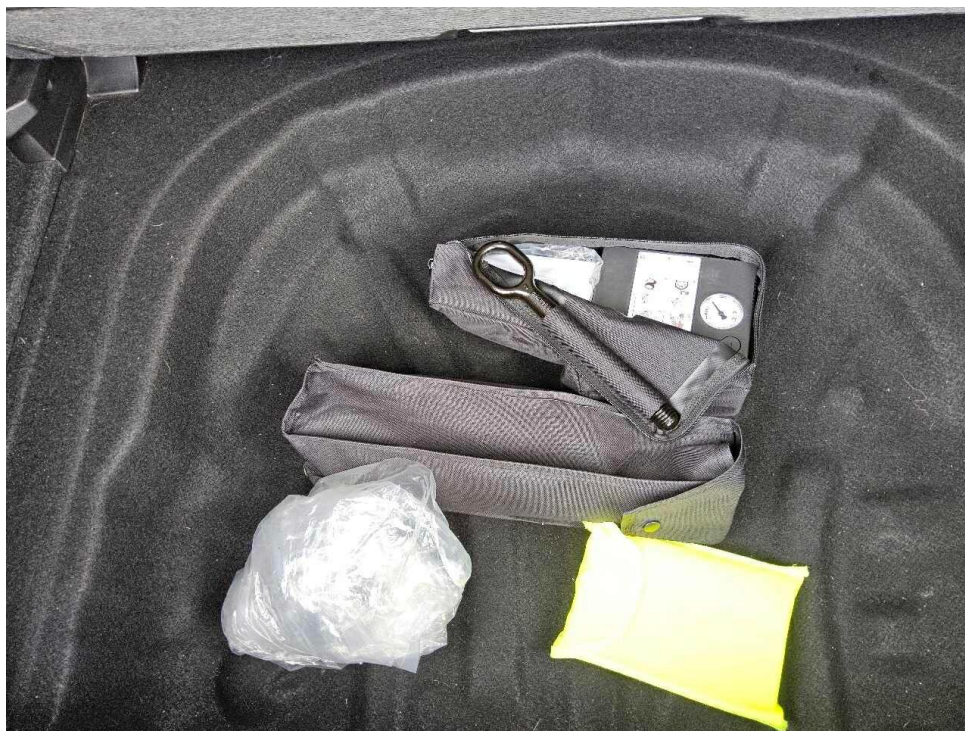
Bild 12 : Bordwerkzeug, Reifendichtmittel und Kompressor
