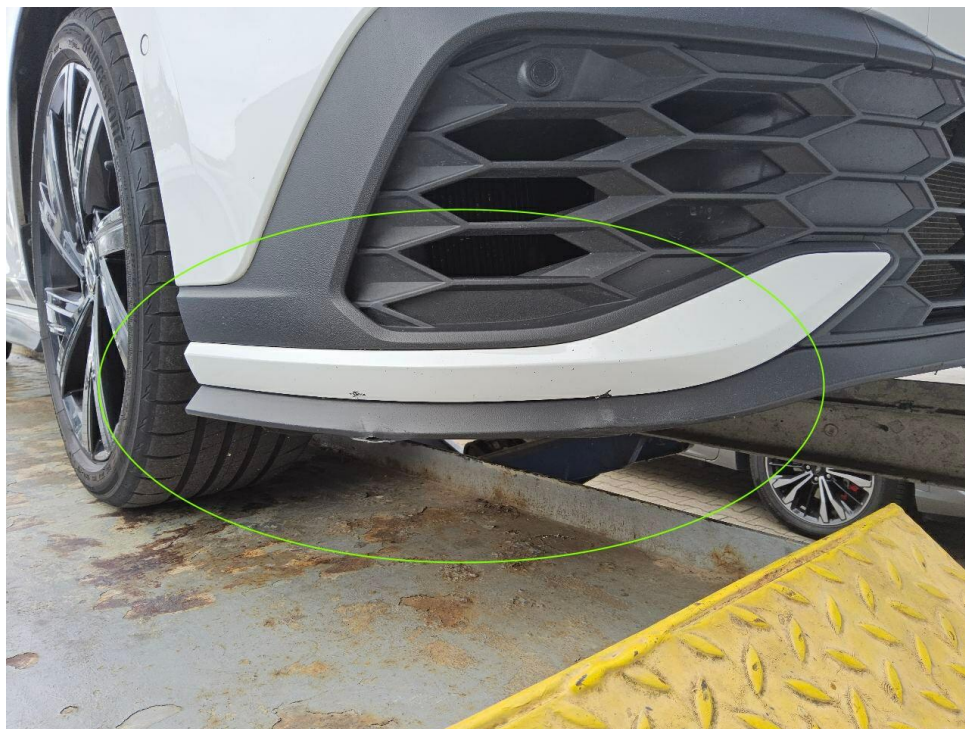
Bild 15 : Stoßfänger vorne rechts verschrammt und Frontspoiler gebrochen
