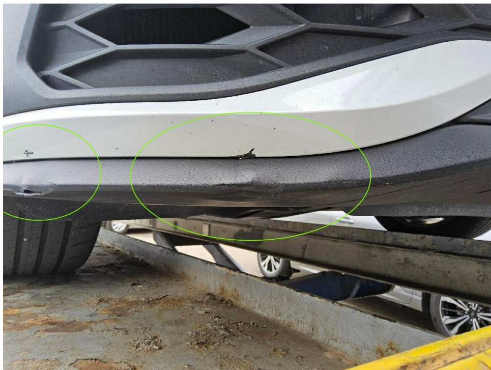
Bild 18 : Stoßfänger vorne rechts verschrammt und Frontspoiler gebrochen
