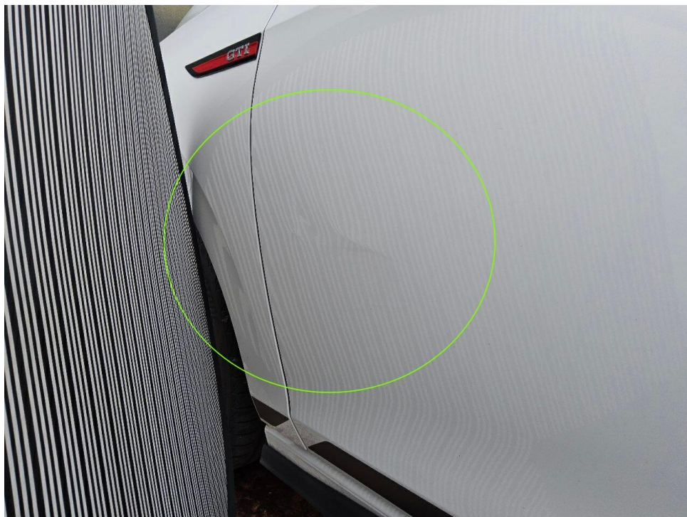
Bild 20 : Tür vorne links eingedrückt und gestaucht
