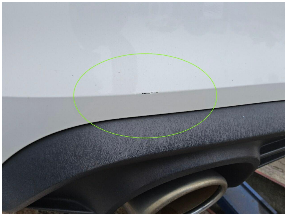
Bild 24 : Stoßfänger hinten links verschrammt
