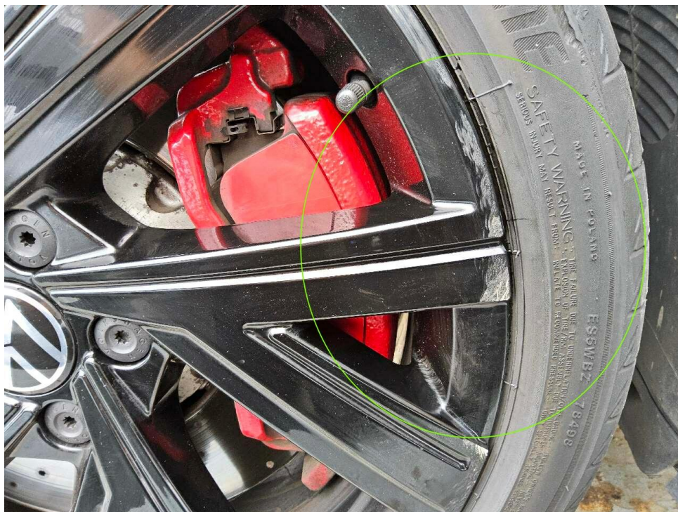
Bild 29 : Felge vorne rechts verschrammt
