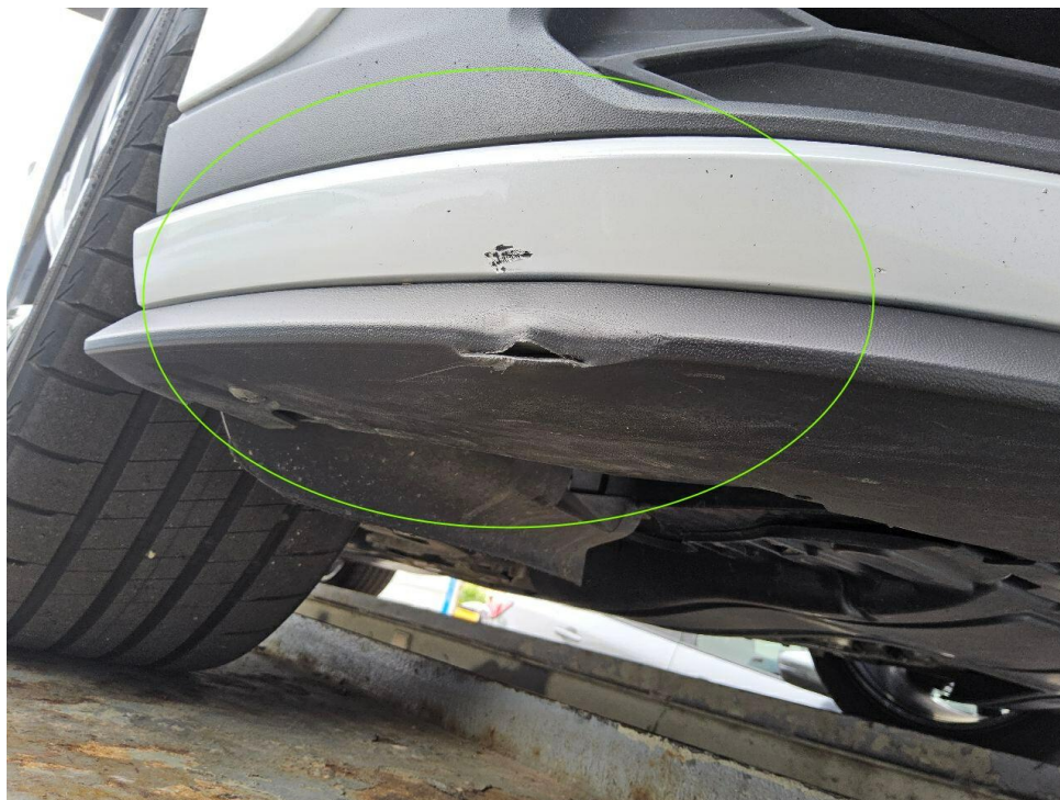
Bild 17 : Stoßfänger vorne rechts verschrammt und Frontspoiler gebrochen
