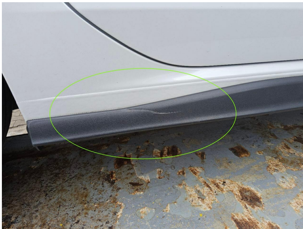
Bild 25 : Schwellerverkleidung rechts verschrammt
