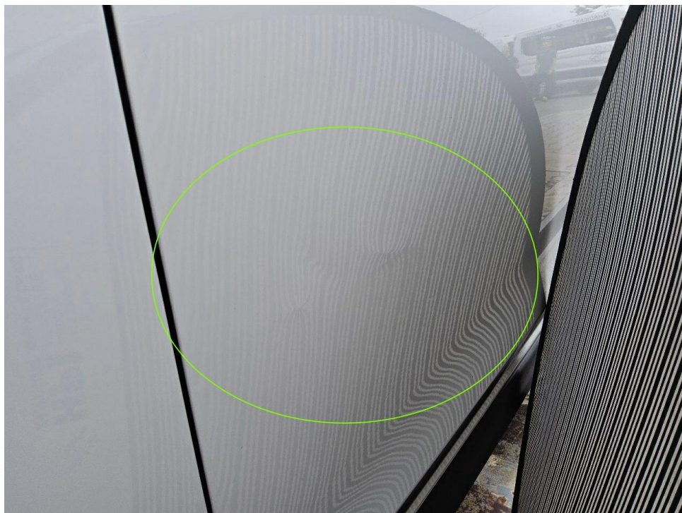
Bild 22 : Tür vorne links eingedrückt und gestaucht
