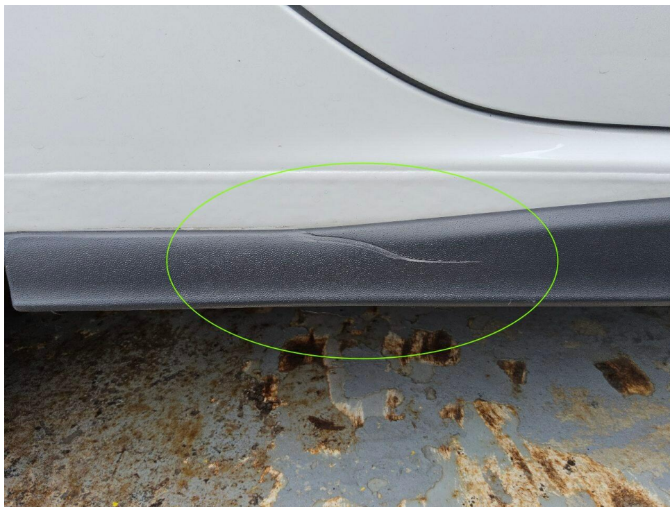
Bild 26 : Schwellerverkleidung rechts verschrammt
