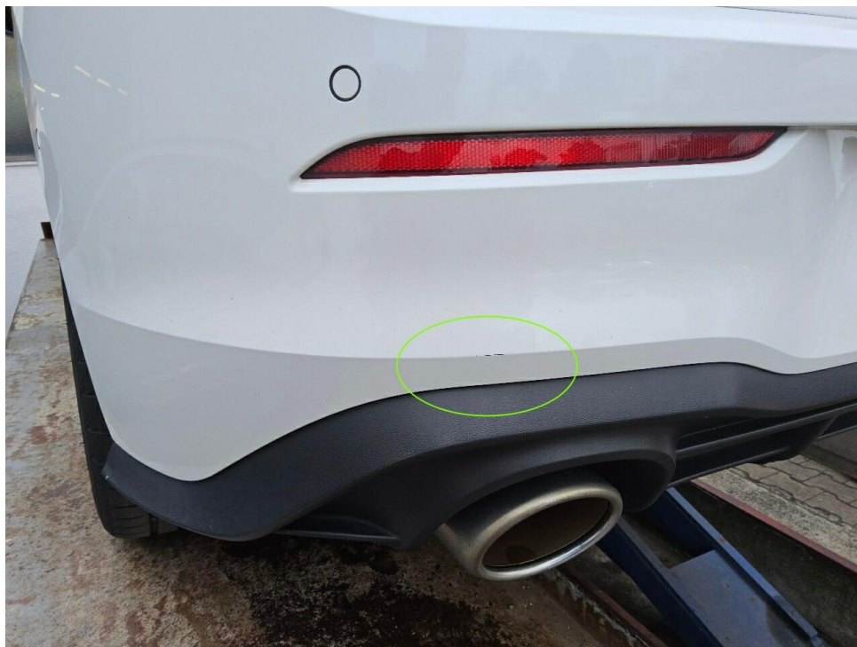
Bild 23 : Stoßfänger hinten links verschrammt
