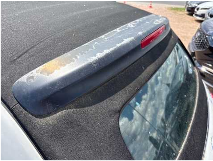
Dach (Anderer Schaden): Abplatzer
