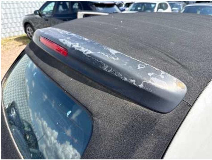
Dach (Anderer Schaden): Abplatzer
