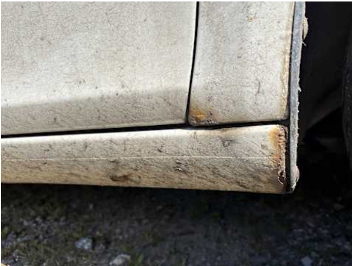
Schweller rechts (Rost)
