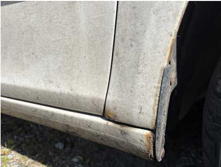
Kotflügel vorne rechts (Rost, Kratzer)
