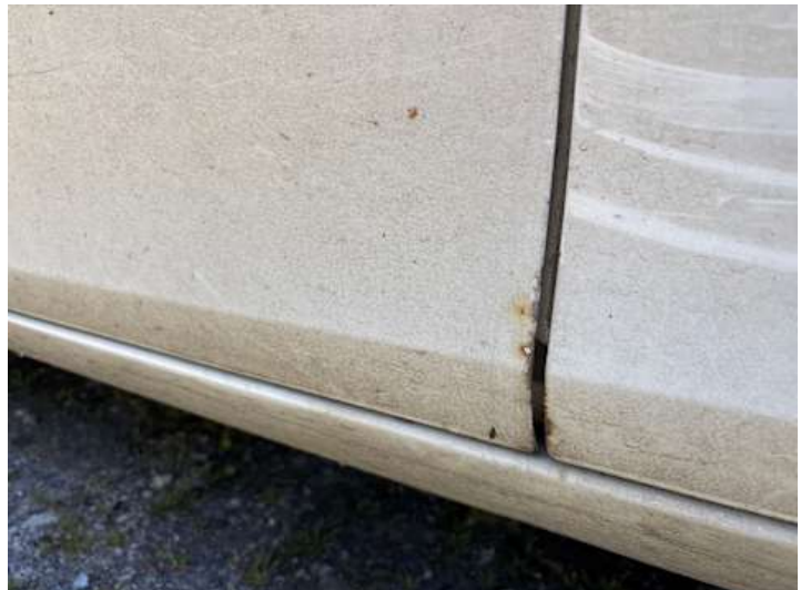
Fahrrertür (Kratzer, Rost)
