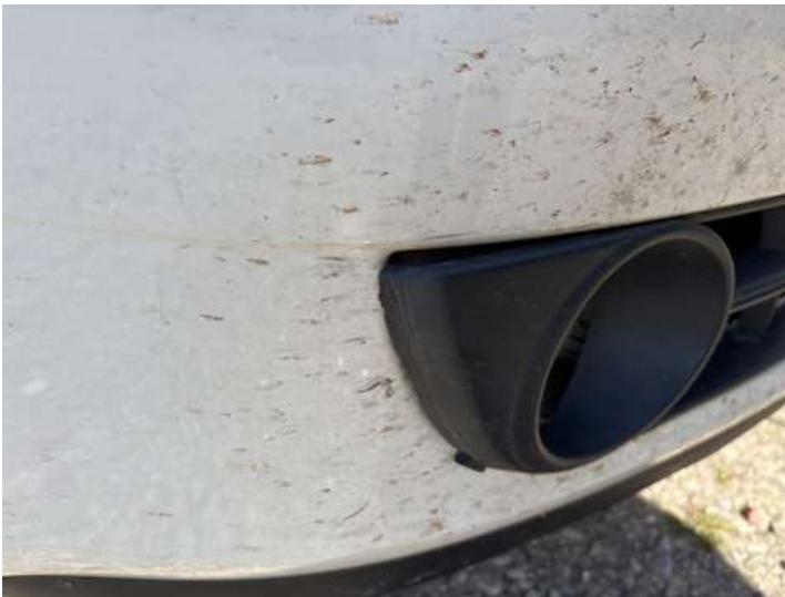
Stoßstange vorne (Spaltmaße ungenau)
