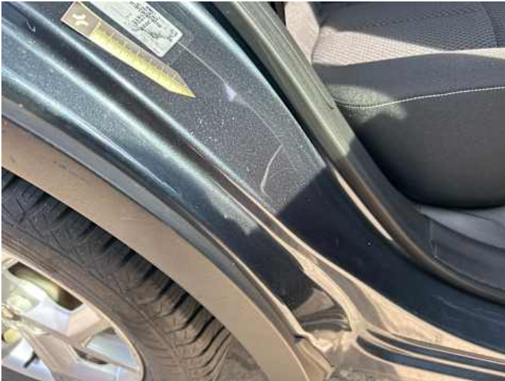
Schweller rechts (Kratzer)
