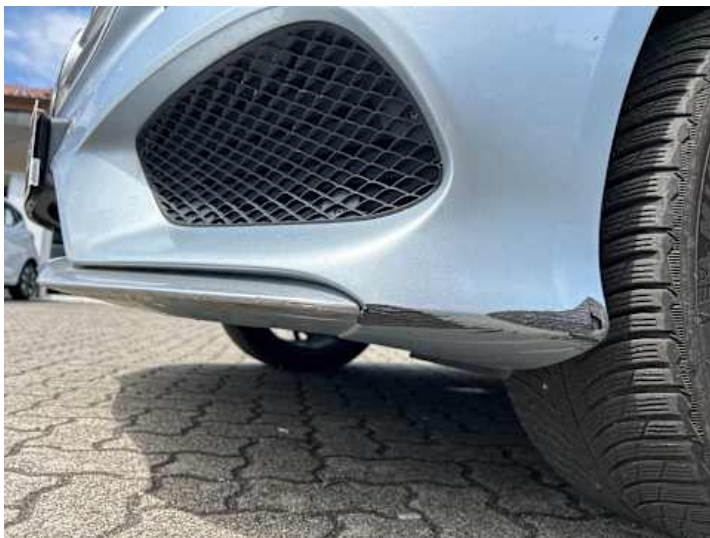
Stoßstange vorne (Kratzer, Riss/Bruch)
