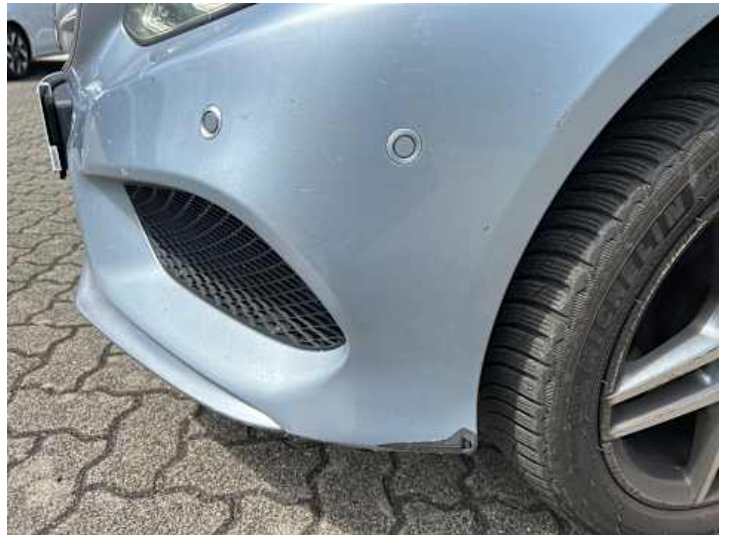
Stoßstange vorne (Kratzer, Riss/Bruch)
