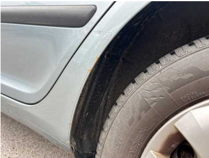
Seitenteil hinten links (Rost)
