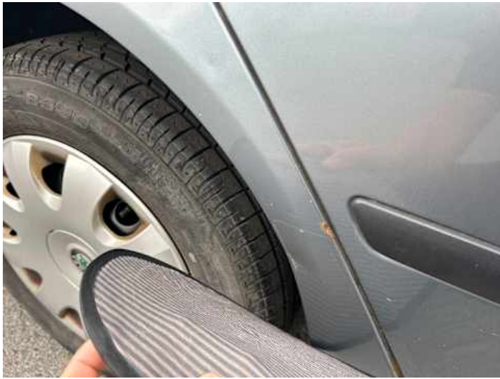
Seitenteil hinten rechts (Rost, Verformung, Delle)
