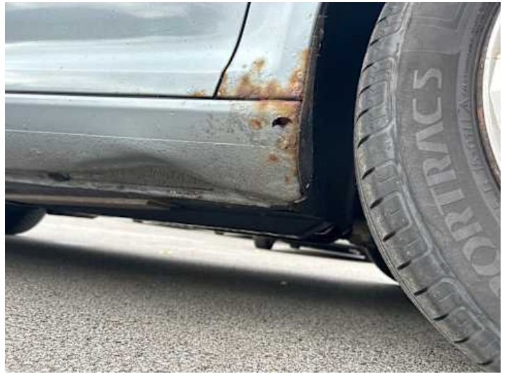
Schweller rechts (Rost, Verformung)
