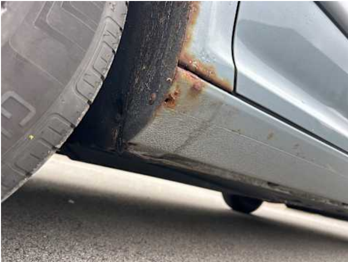
Schweller links (Rost)
