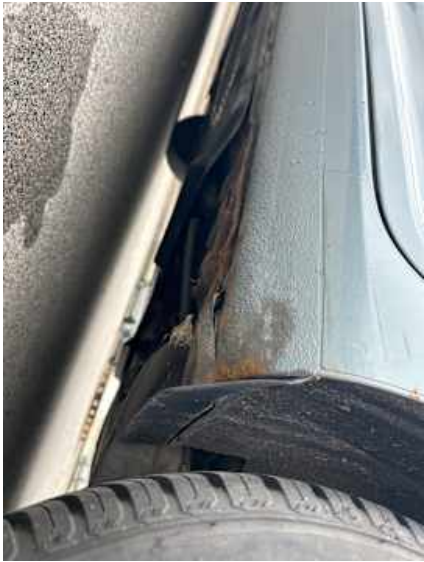
Schweller links (Rost)
