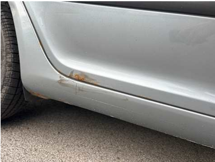
Türe hinten rechts (Rost)
