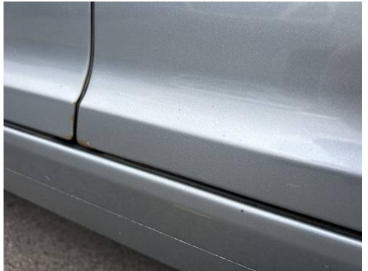
Türe hinten links (Rost)
