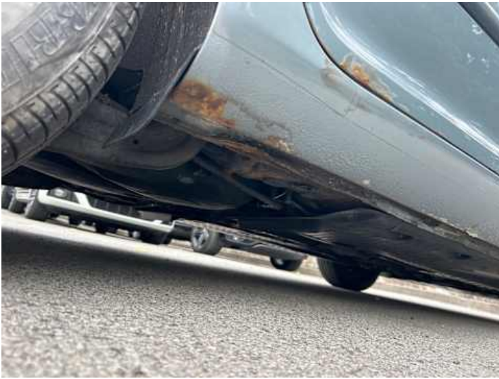
Schweller rechts (Rost, Verformung)
