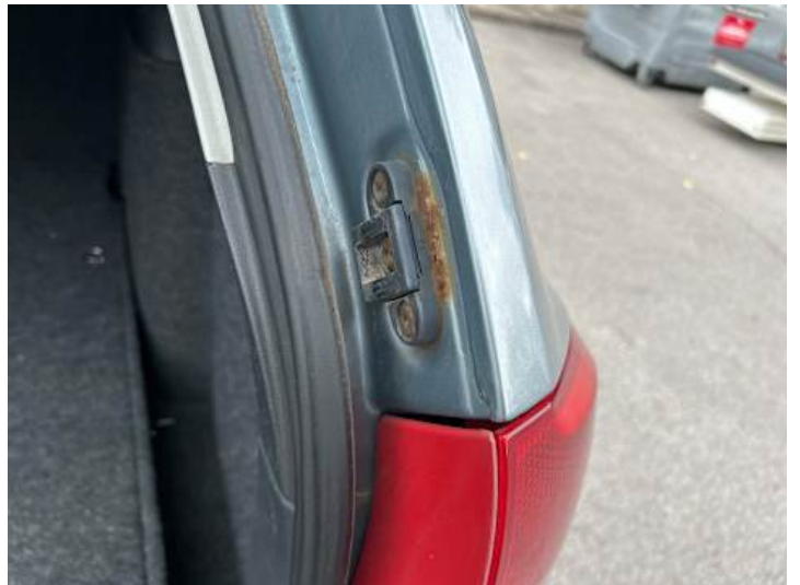
Seitenteil hinten rechts (Rost)
