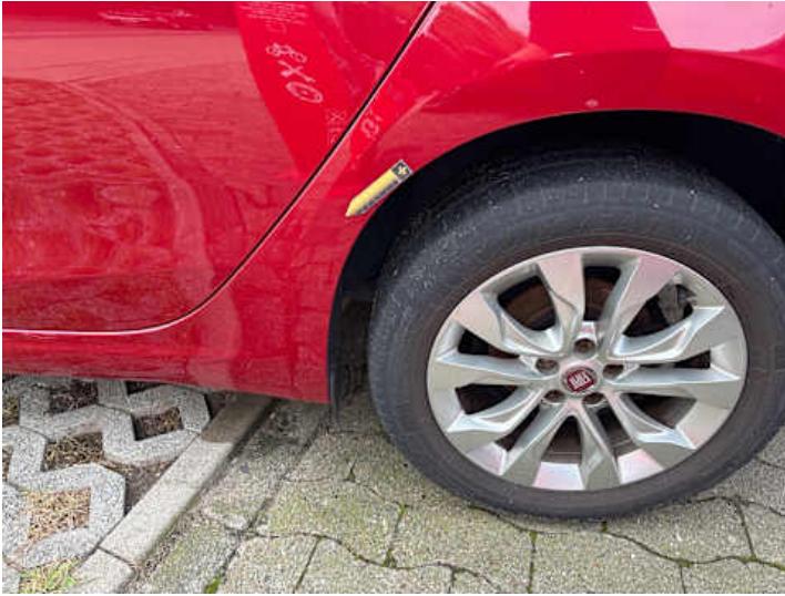
Seitenteil hinten links (Lackschaden)
