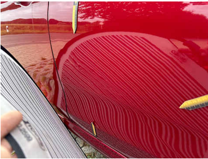
Türe hinten links (Lackschaden, Verformung)
