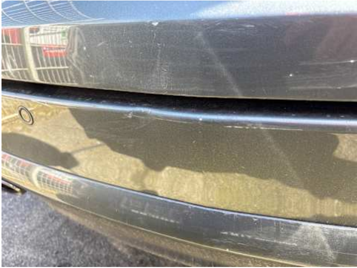
Stoßstange hinten (Kratzer, Verformung)
