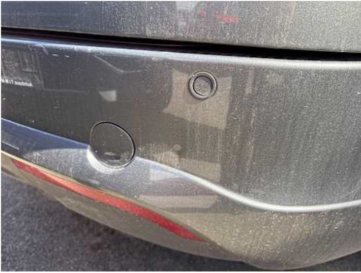
Stoßstange hinten (Kratzer, Verformung)
