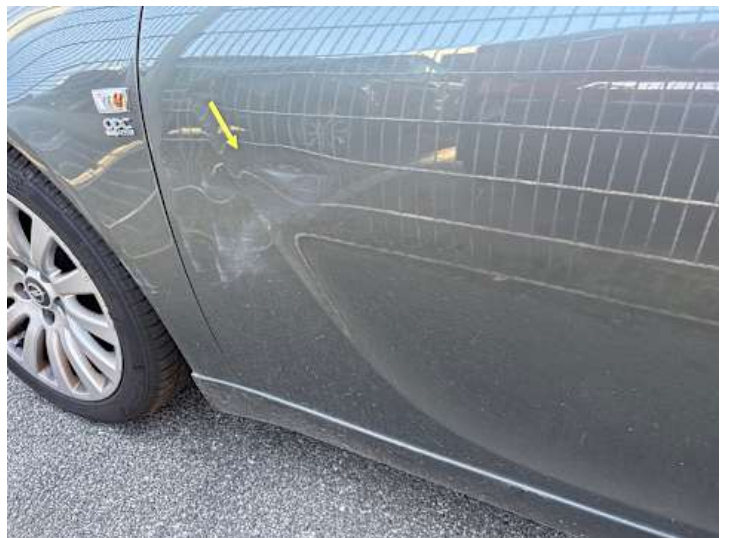
Fahrtür (Kratzer, Verformung)
