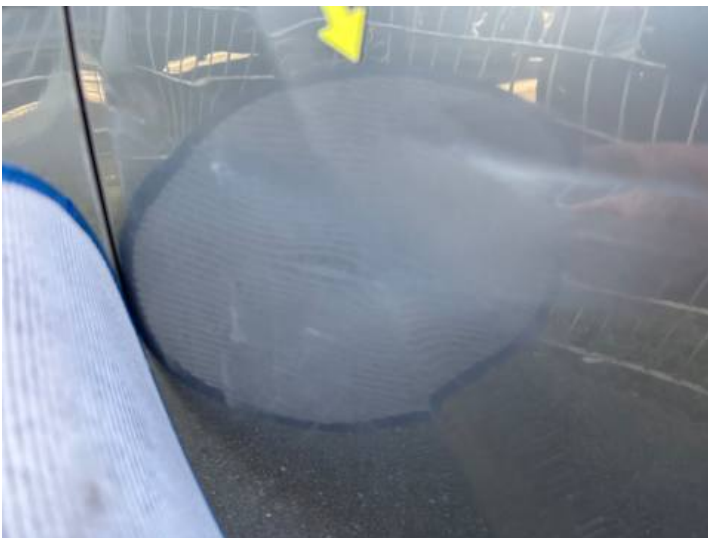
Fahrtür (Kratzer, Verformung)
