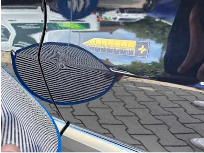
Türe hinten links (Lackschaden, Delle)
