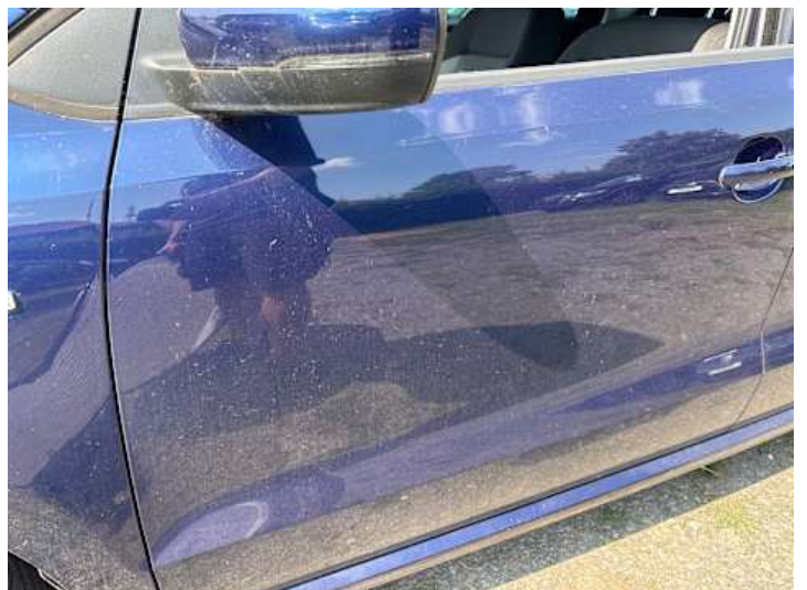
Fahrtür (Delle, Kratzer)
