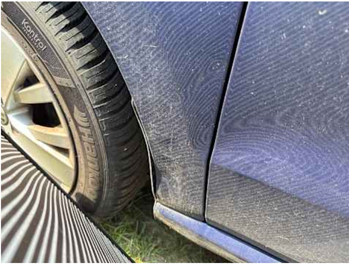
Kotflügel vorne links (Delle, Verformung)
