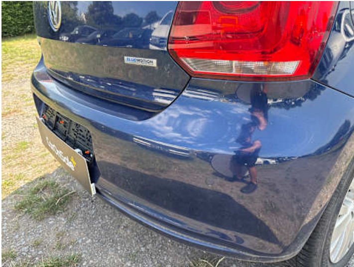
Stoßstange hinten (Kratzer, Riss/Bruch, Verformung)
