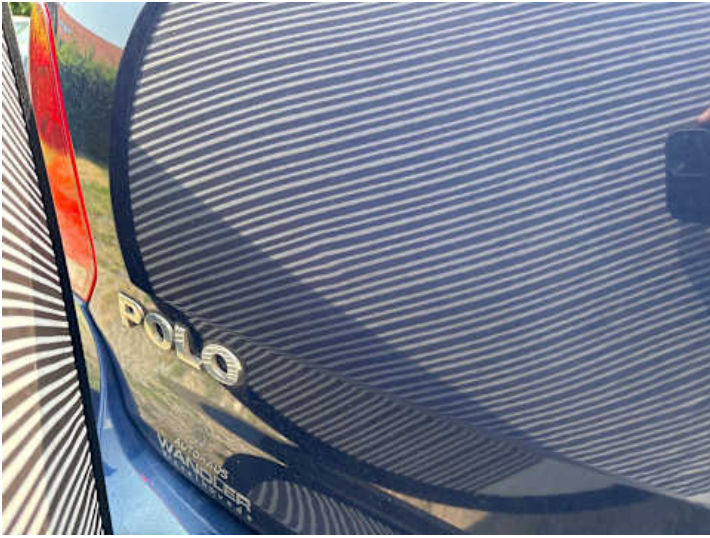
Heckklappe (Delle, Kratzer)
