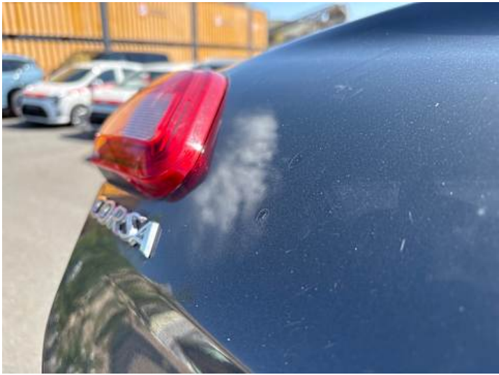
Heckklappe (Lackschaden, Delle)
