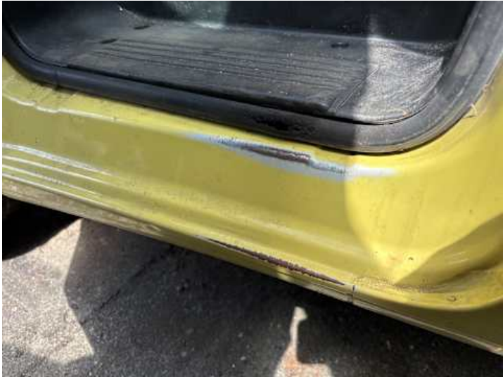
Schweller links (Kratzer, Rost)
