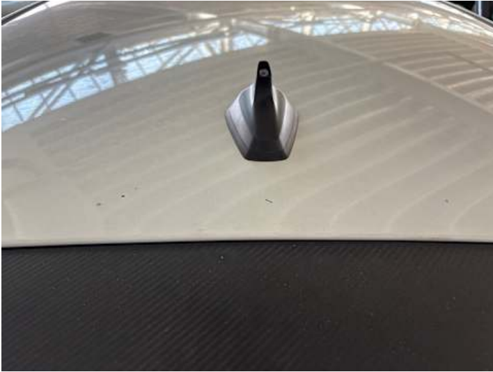
Dach (Anderer Schaden): Antenne fehlt
