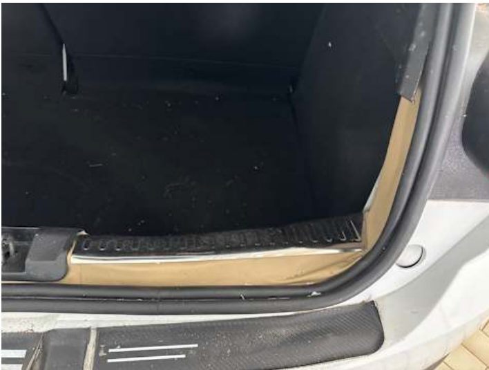
Innenraum (Anderer Schaden): Unsachgemäß instand gesetzt
