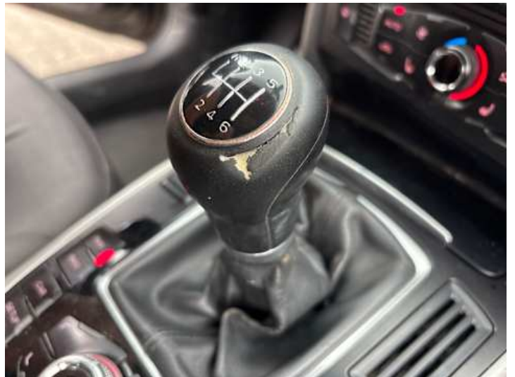
Innenraum (Verschleiß, Riss/Bruch)
