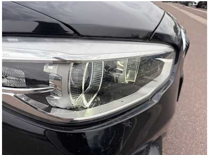
Scheinwerfer (rechts) (Steinschlag)
