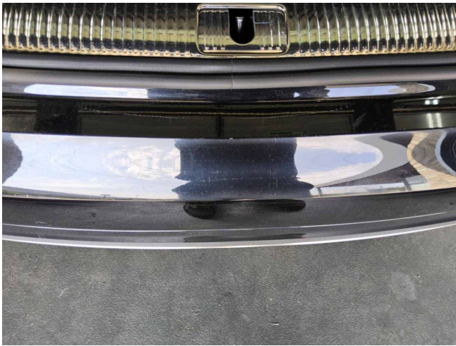
Stoßfänger hinten Lackierung, zerkratzt, smart repair (DEKRA)
