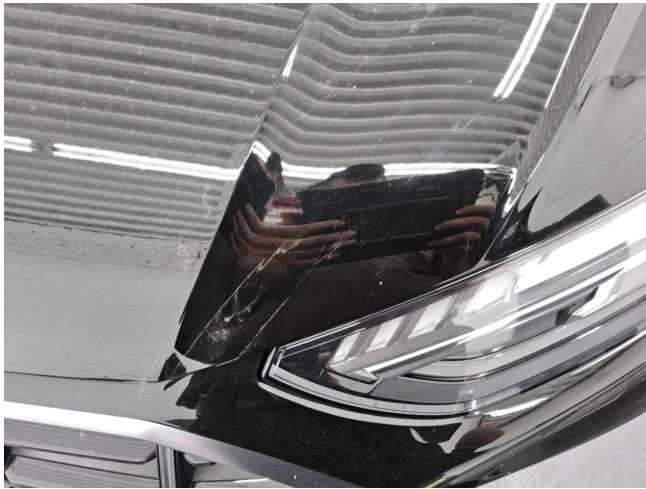
Motorhaube Lackierung, Steinschlag, Gebrauchsspur (DEKRA)
