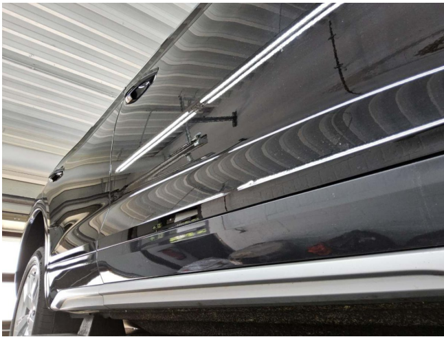
Tür vorne rechts, eingedellt, instandsetzen und lackieren mit Lackaufbau (DEKRA)
