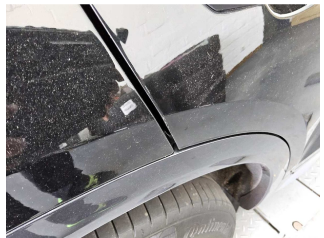
Tür hinten rechts Türkante, zerkratzt, Gebrauchsspur (DEKRA)
