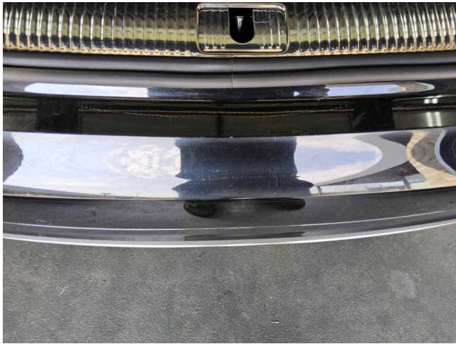
Stoßfänger hinten Lackierung, zerkratzt, smart repair (DEKRA)
