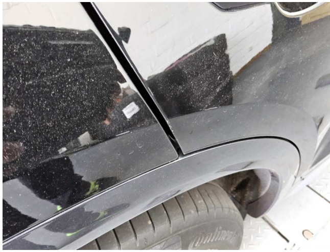
Tür hinten rechts Türkante, zerkratzt, Gebrauchsspur (DEKRA)
