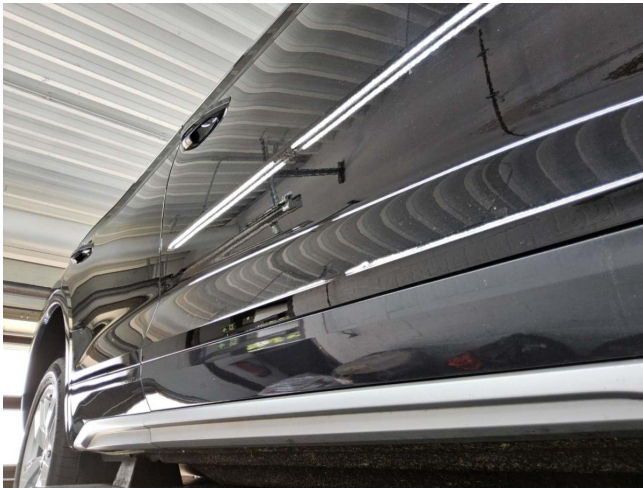
Tür vorne rechts, eingedellt, instandsetzen und lackieren mit Lackaufbau (DEKRA)
