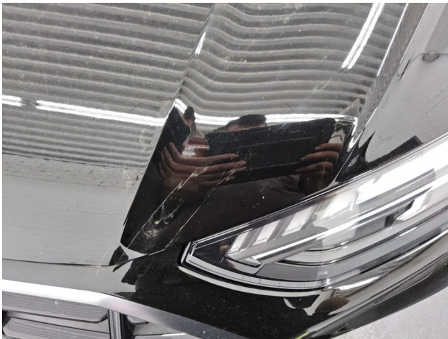
Motorhaube Lackierung, Steinschlag, Gebrauchsspur (DEKRA)
