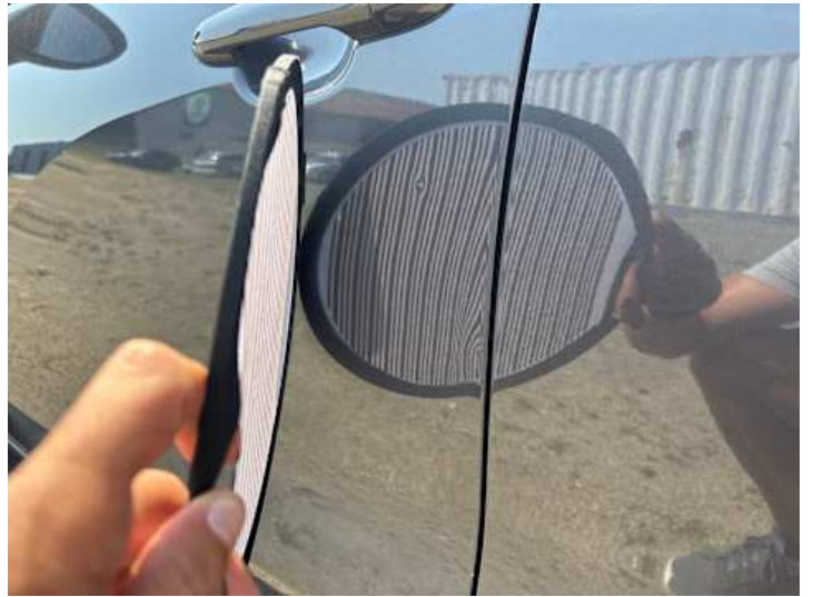
Fahrtür (Delle, Verformung)
