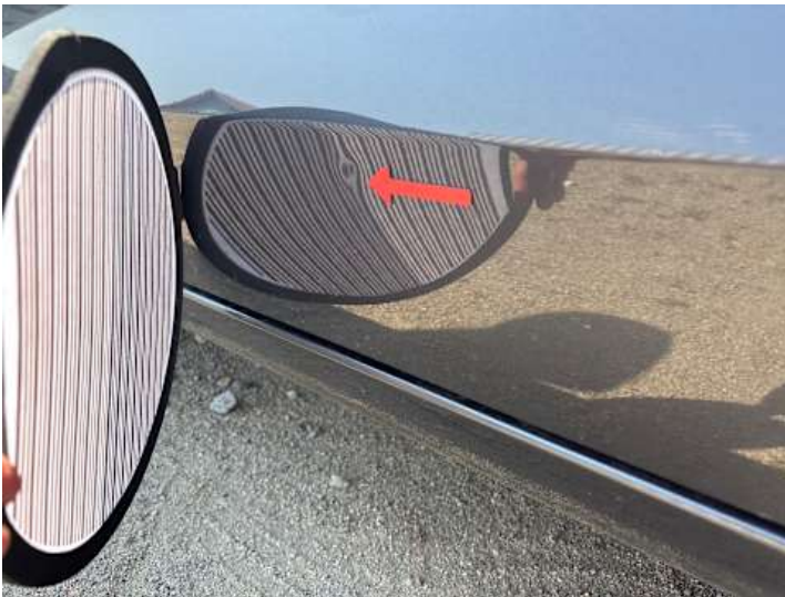
Fahrtür (Delle, Verformung)
