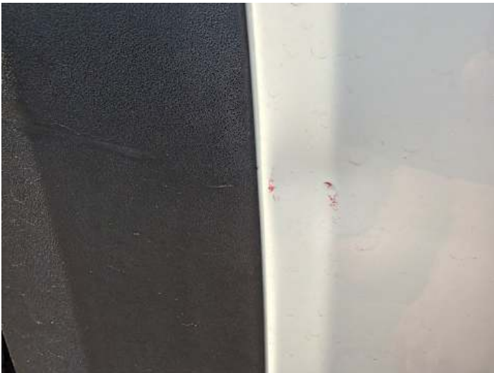
Türe hinten rechts (Kratzer, Lackschaden, Delle)
