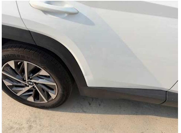
Türe hinten rechts (Kratzer, Lackschaden, Delle)
