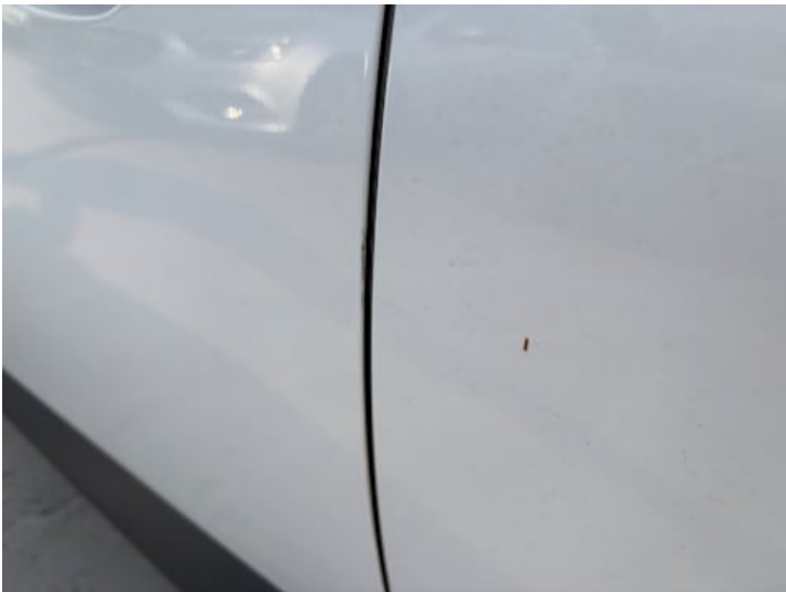
Fahrtür (Lackschaden, Kratzer)
