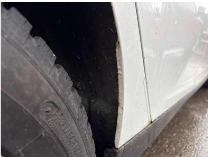
Seitenteil hinten rechts (Rost)
