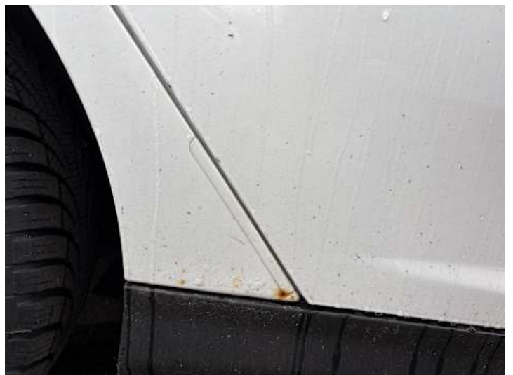
Seitenteil hinten rechts (Rost)
