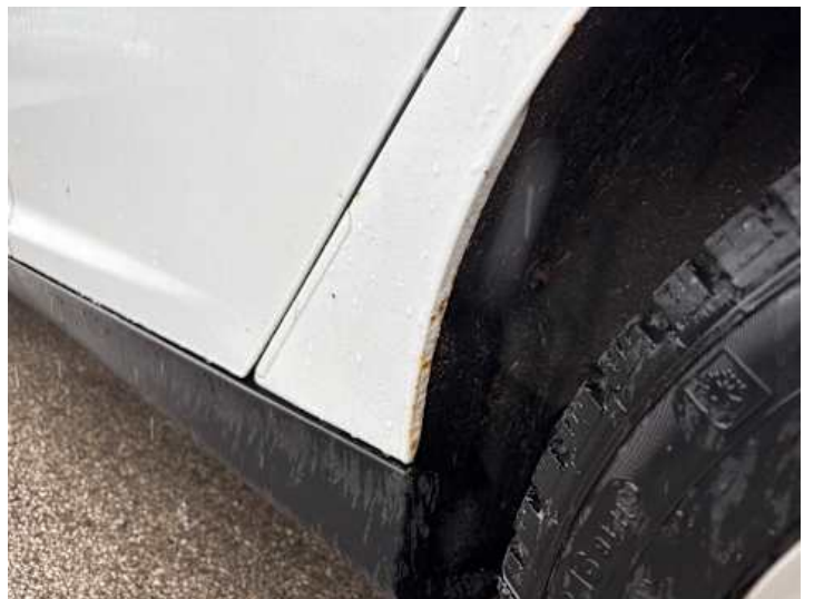
Seitenteil hinten links (Rost, Delle)
