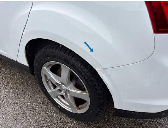
Seitenteil hinten links (Rost, Delle)
