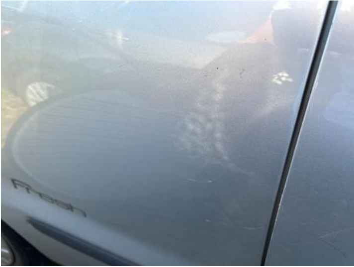
Seitenteil hinten rechts (Kratzer, Delle)
