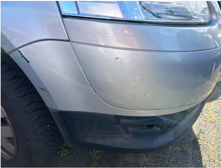
Stoßstange vorne (Kratzer, Lackschaden)
