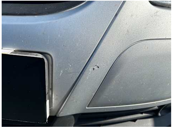
Stoßstange vorne (Kratzer, Lackschaden)
