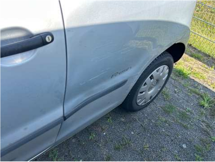
Seitenteil hinten links (Lackschaden, Verformung, Rost)
