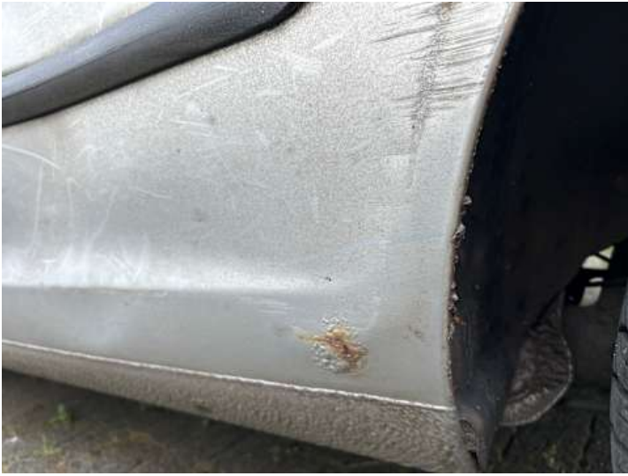
Seitenteil hinten links (Lackschaden, Verformung, Rost)
