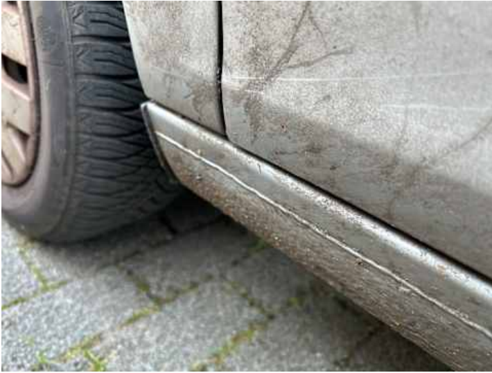
Schweller links (Verformung)
