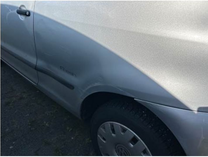
Seitenteil hinten links (Lackschaden, Verformung, Rost)
