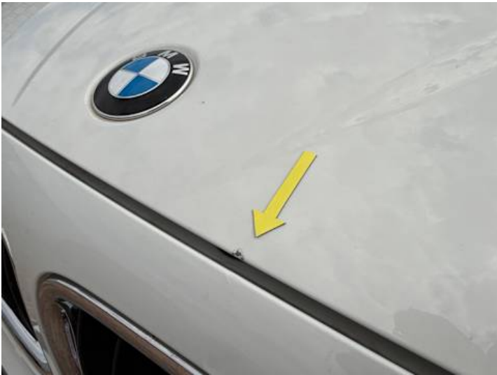
Motorhaube (Steinschlag, Lackschaden)
