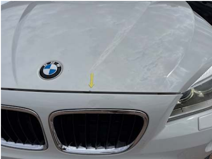
Motorhaube (Steinschlag, Lackschaden)
