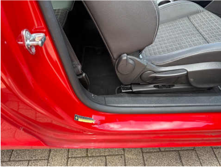
Schweller rechts (Delle, Lackschaden)
