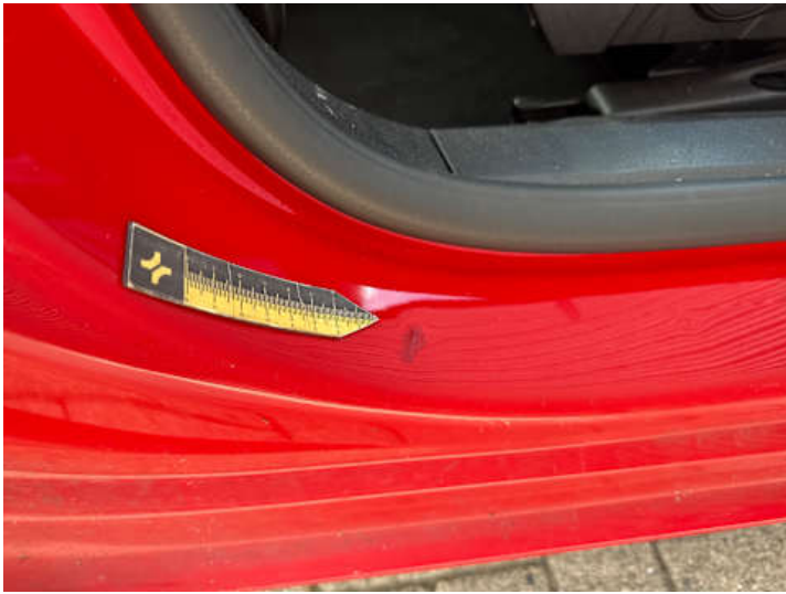
Schweller rechts (Delle, Lackschaden)
