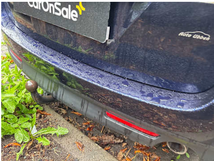
Stoßstange hinten (Kratzer, Riss/Bruch)
