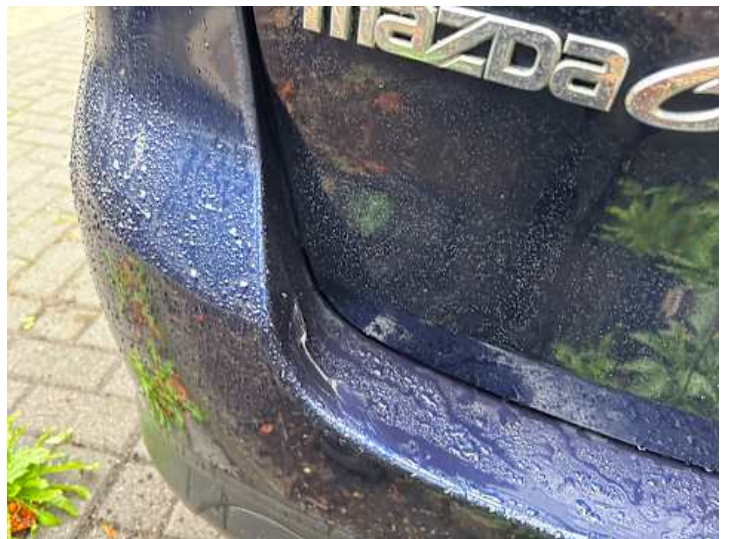
Stoßstange hinten (Kratzer, Riss/Bruch)
