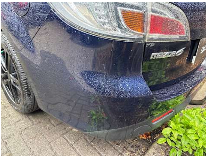
Stoßstange hinten (Kratzer, Riss/Bruch)
