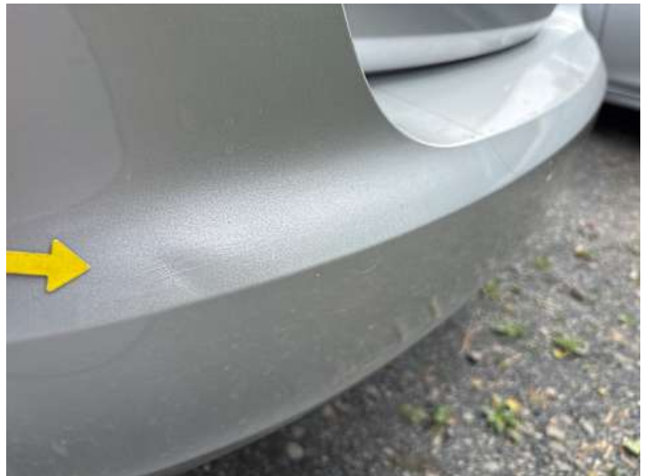
Stoßstange hinten (Verformung)
