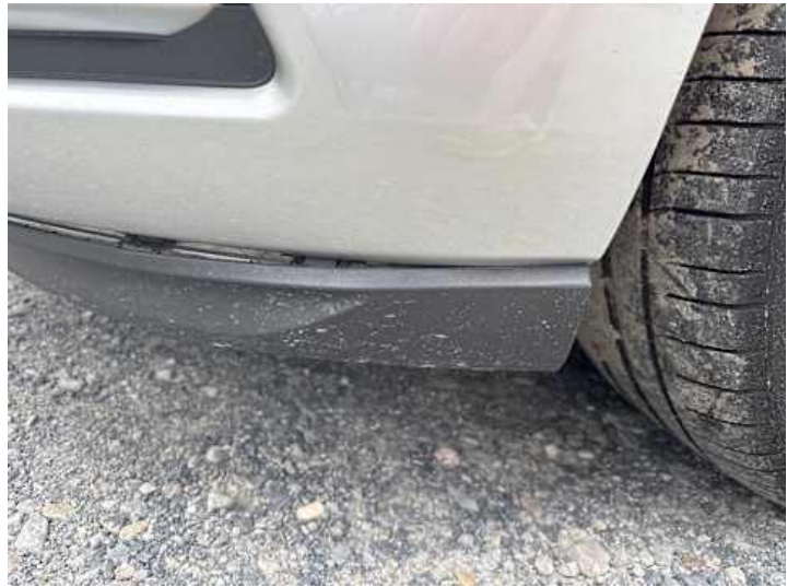
Stoßstange vorne (Spaltmaße ungenau)
