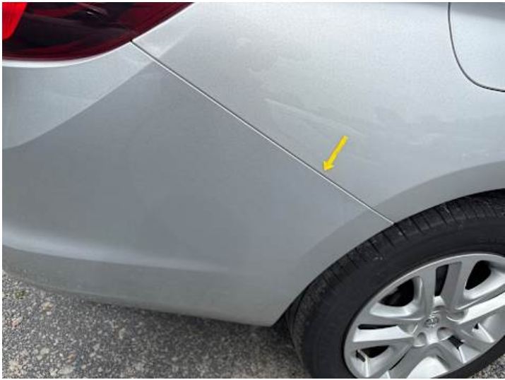
Stoßstange hinten (Unsachgemäß instand gesetzt)
