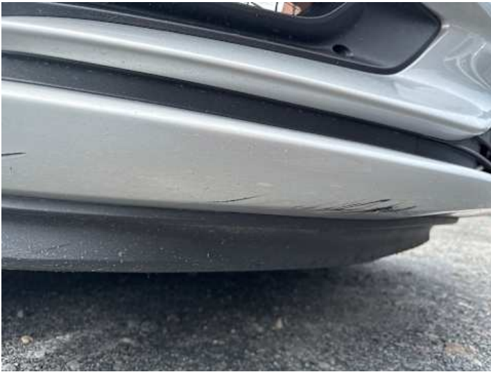
Stoßstange vorne (Lackschaden, Kratzer)
