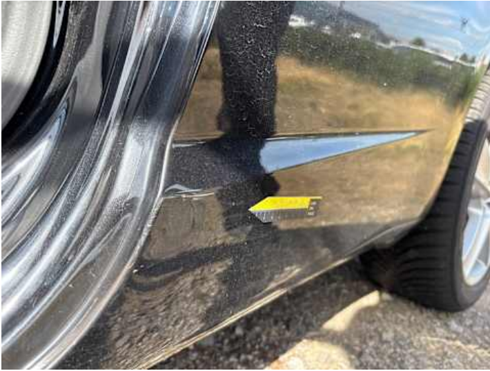
Seitenteil hinten links (Verformung, Lackschaden)
