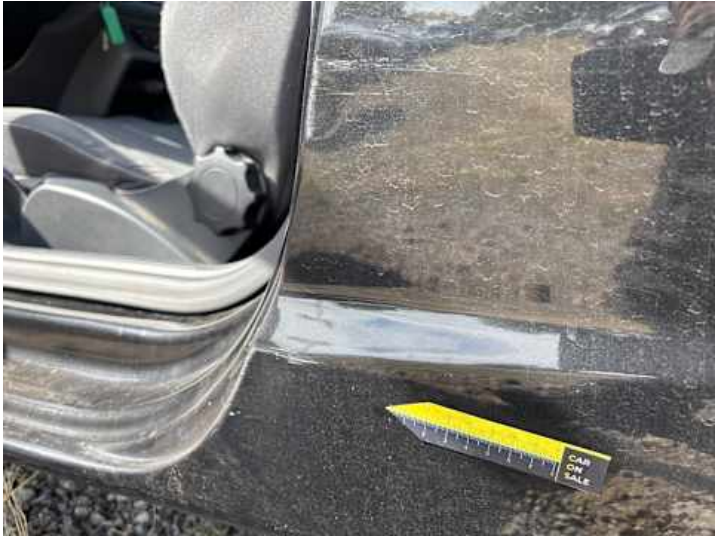
Seitenteil hinten links (Verformung, Lackschaden)
