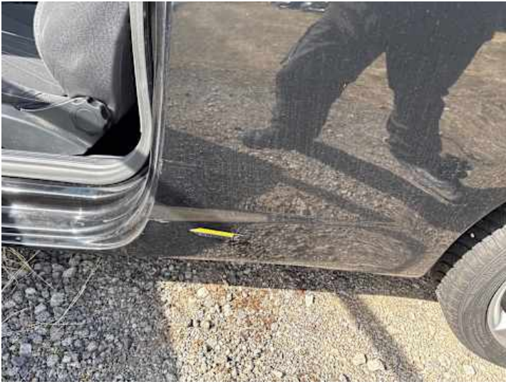
Seitenteil hinten links (Verformung, Lackschaden)
