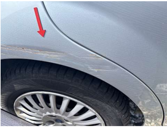
Seitenteil hinten rechts (Kratzer, Verformung, Rost)
