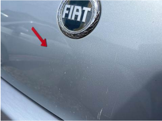
Heckklappe (Kratzer, Delle)
