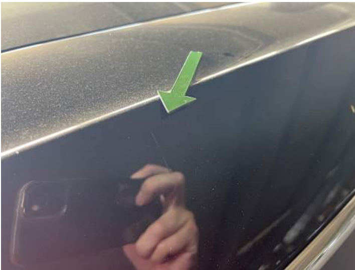
Heckklappe (Lackschaden, Kratzer)
