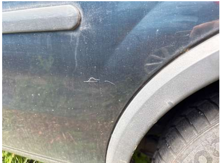
Seitenteil hinten links (Lackschaden)
