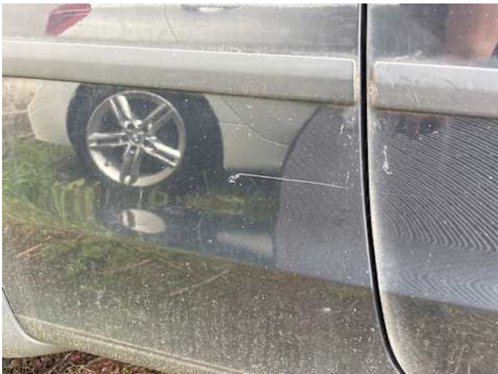
Seitenteil hinten rechts (Lackschaden)
