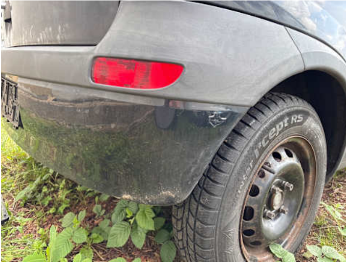
Stoßstange hinten (Lackschaden, Kratzer)
