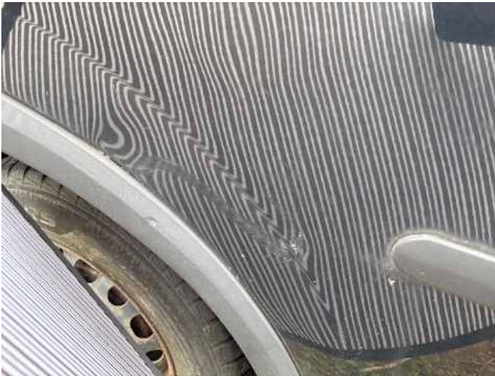
Seitenteil hinten rechts (Lackschaden, Verformung)
