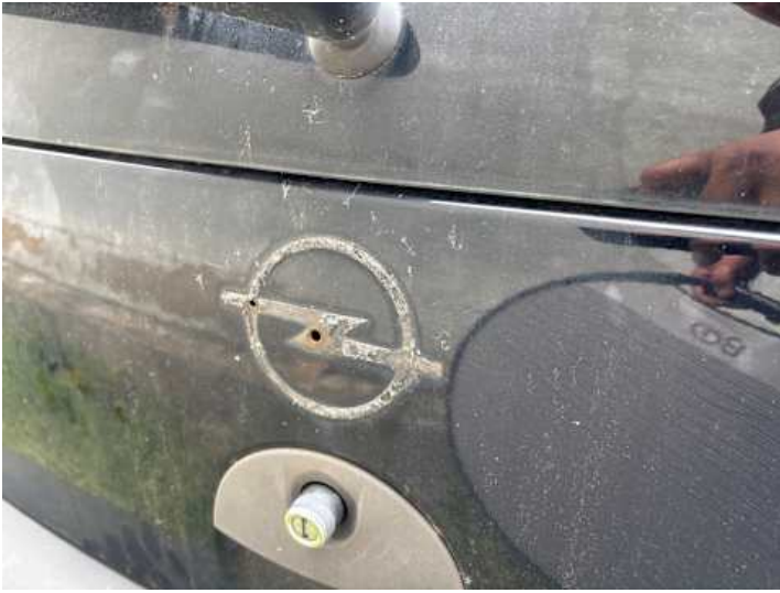
Heckklappe (Anderer Schaden): Emblem fehlt
