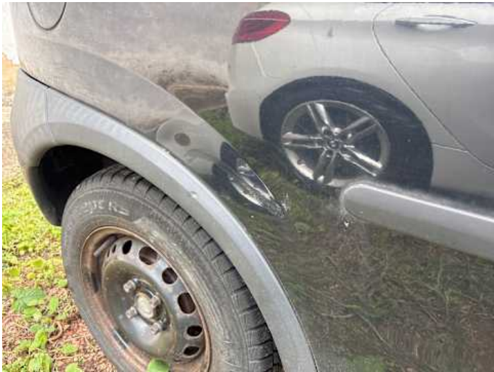
Seitenteil hinten rechts (Lackschaden, Verformung)
