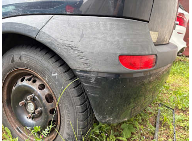
Stoßstange hinten (Lackschaden, Kratzer)
