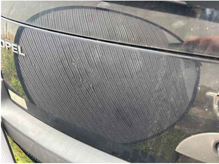
Heckklappe (Delle, Lackschaden)
