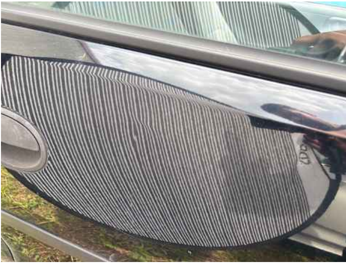
Beifahrertür (Delle, Lackschaden)
