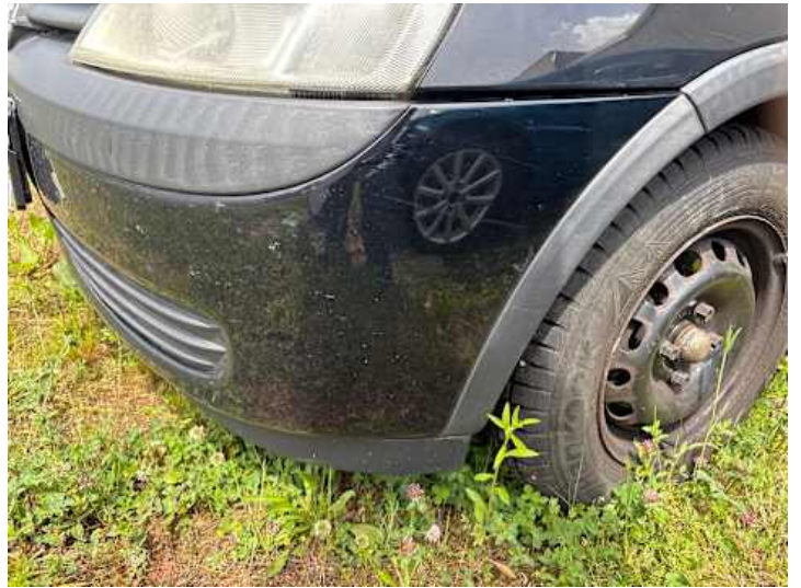
Stoßstange vorne (Lackschaden, Spaltmaße ungenau)
