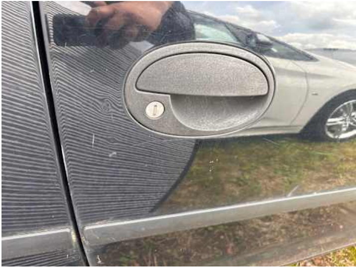
Beifahrtür (Delle, Lackschaden)
