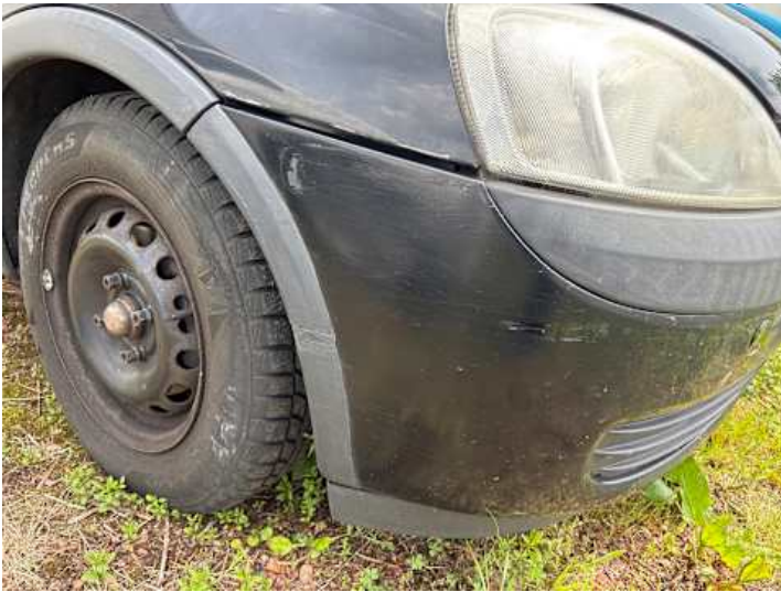
Stoßstange vorne (Lackschaden, Spaltmaße ungenau)
