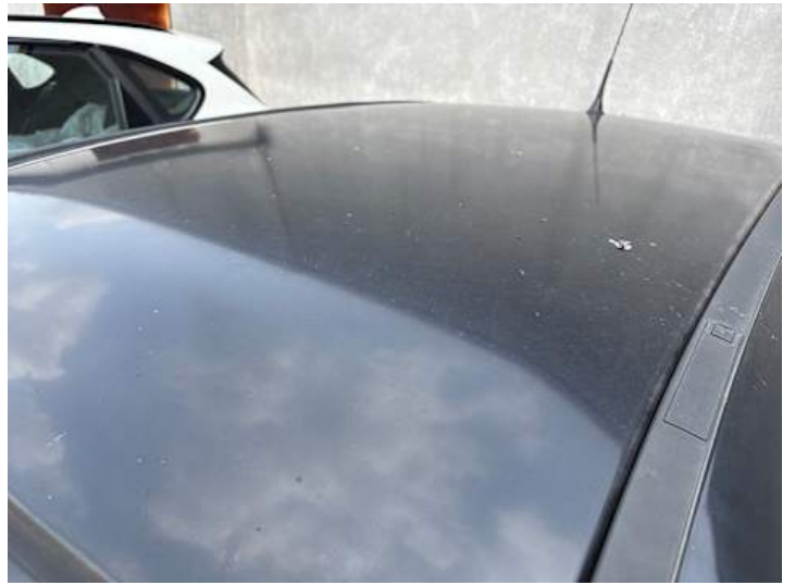
Dach (Ausgeblichen/Matt, Kratzer)
