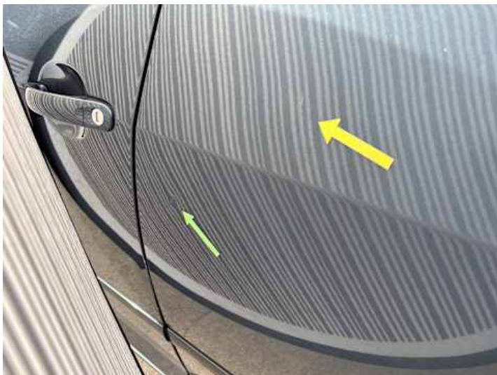
Türe hinten links (Delle, Kratzer)
