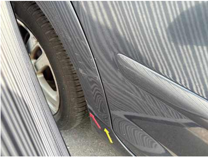
Seitenteil hinten rechts (Kratzer, Verformung, Rost)
