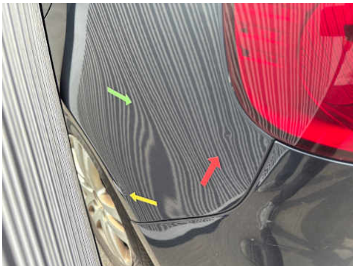
Seitenteil hinten links (Delle, Kratzer)
