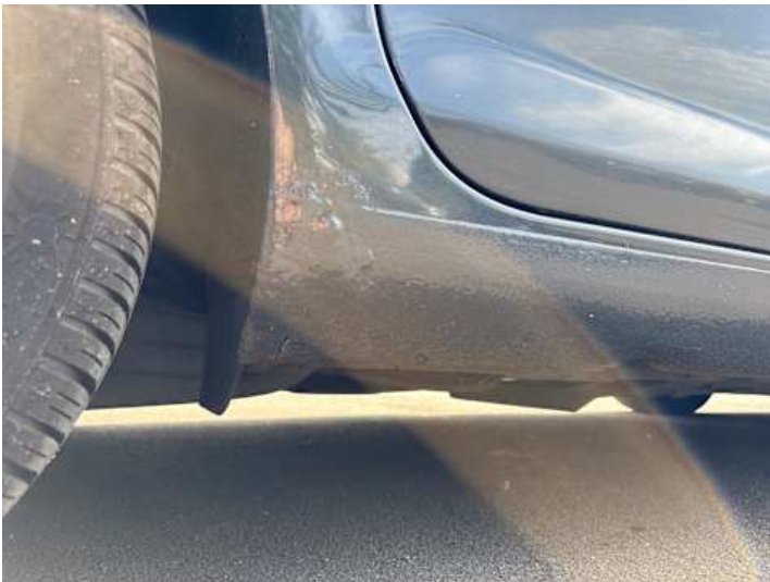
Schweller rechts (Kratzer, Rost)
