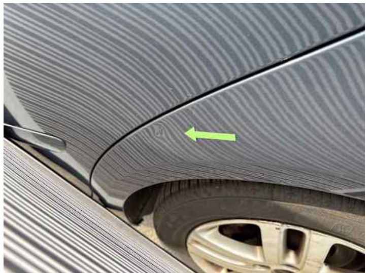
Seitenteil hinten links (Delle, Kratzer)
