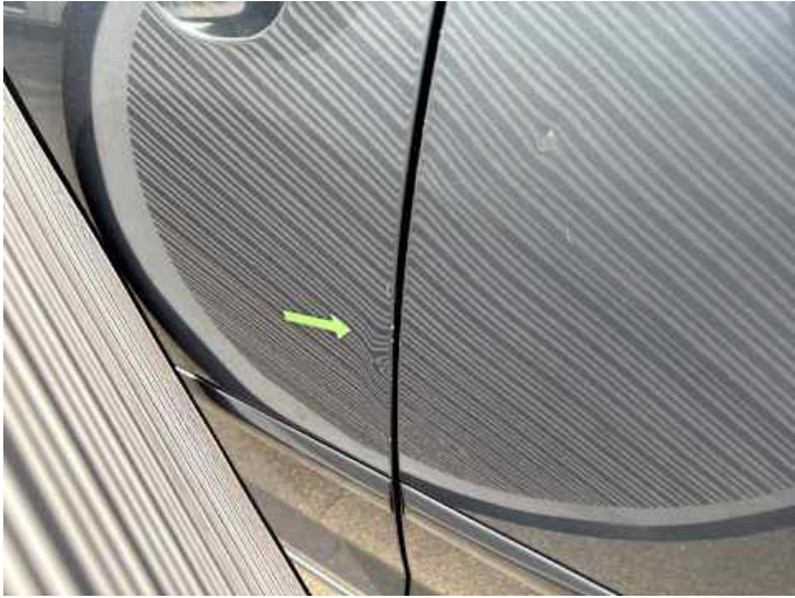
Fahrtür (Kratzer, Verformung)
