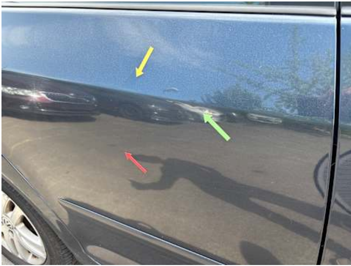
Türe hinten rechts (Kratzer, Delle)
