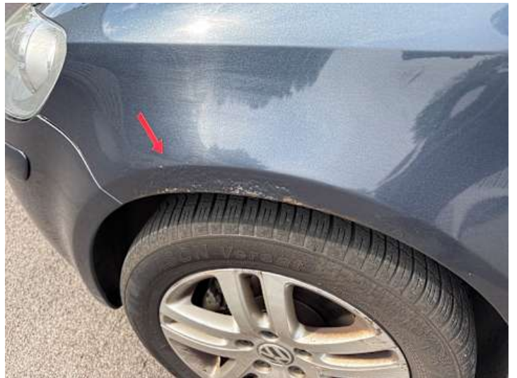
Kotflügel vorne links (Kratzer, Rost)
