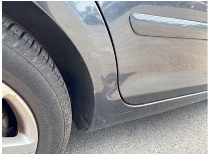
Schweller rechts (Kratzer, Rost)
