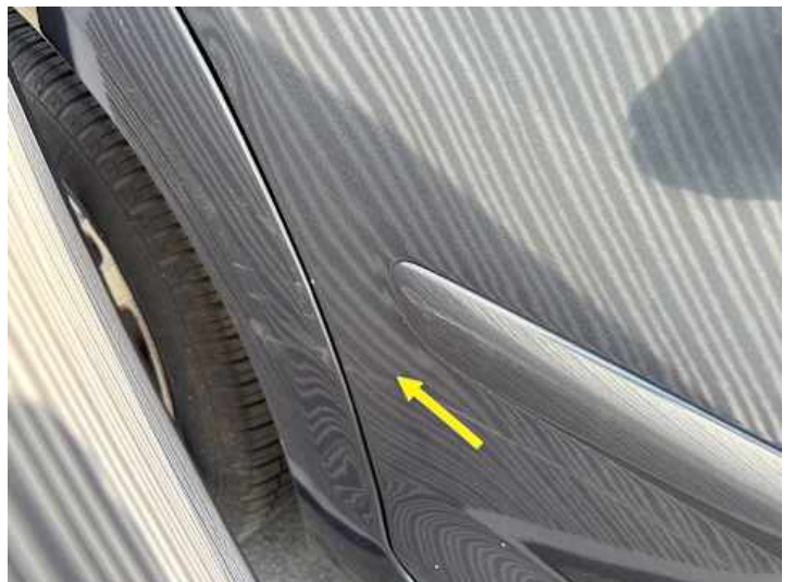
Türe hinten rechts (Verformung)
