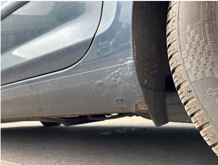
Schweller links (Kratzer, Rost)
