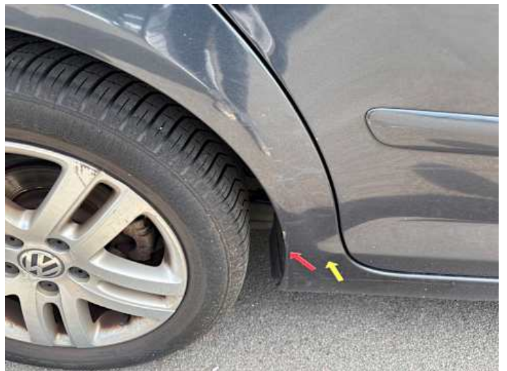
Seitenteil hinten rechts (Kratzer, Verformung, Rost)
