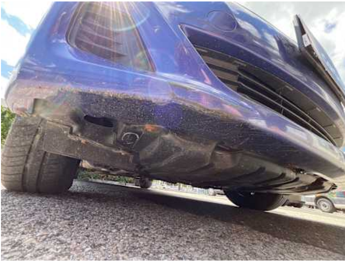
Stoßstange vorne (Kratzer, Lackschaden)
