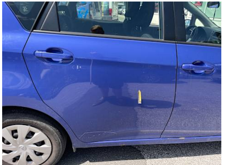
Türe hinten rechts (Kratzer, Lackschaden)
