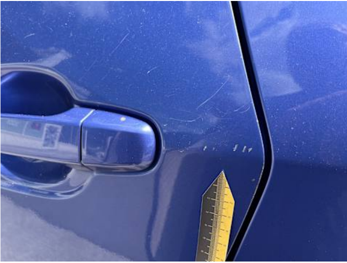
Türe hinten links (Kratzer, Lackschaden)
