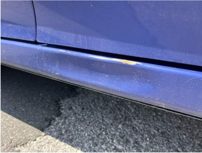
Schweller rechts (Rost, Lackschaden, Verformung)
