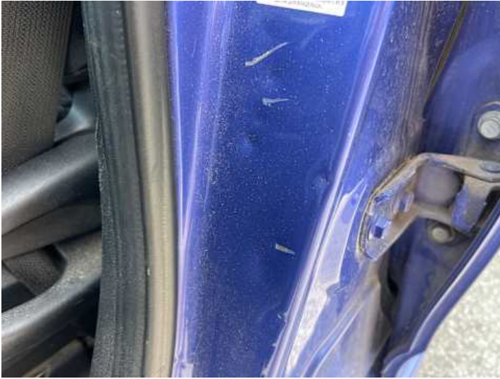
Fahrtür (Kratzer, Lackschaden, Delle)
