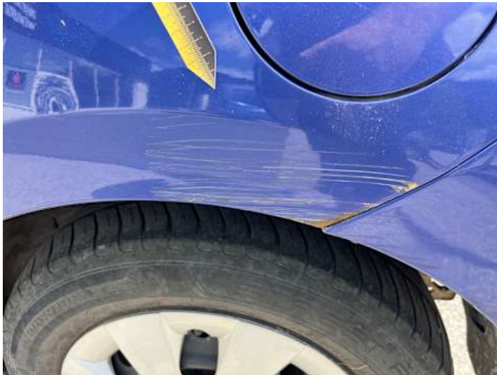
Seitenteil hinten links (Kratzer, Lackschaden, Rost, Delle)
