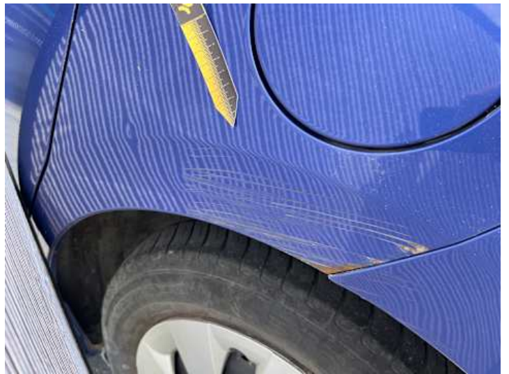
Seitenteil hinten links (Kratzer, Lackschaden, Rost, Delle)
