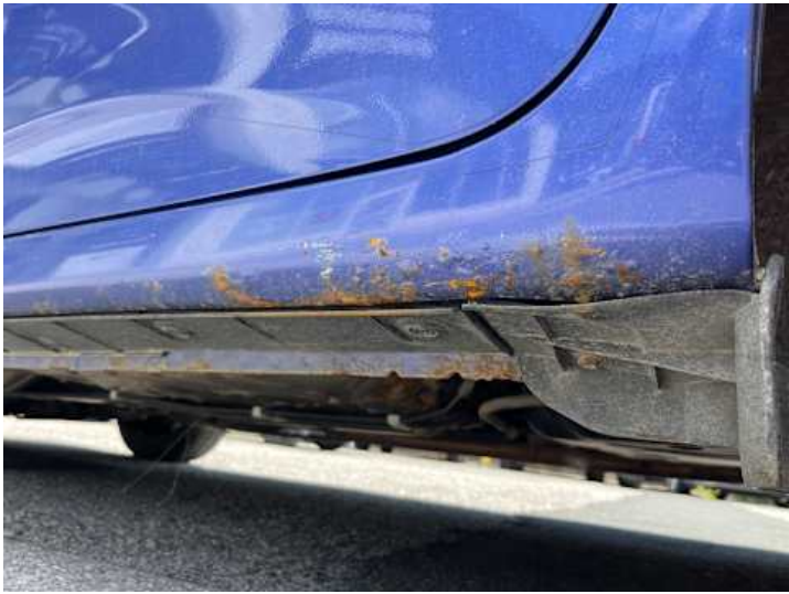
Schweller links (Rost, Lackschaden)
