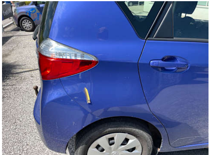
Seitenteil hinten rechts (Kratzer, Lackschaden, Delle)
