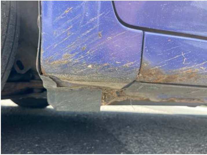
Kotflügel vorne links (Rost, Lackschaden)
