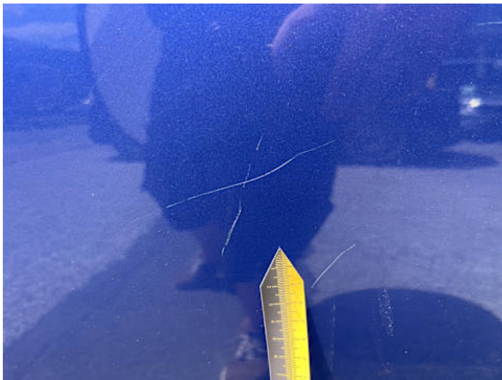
Türe hinten rechts (Kratzer, Lackschaden)
