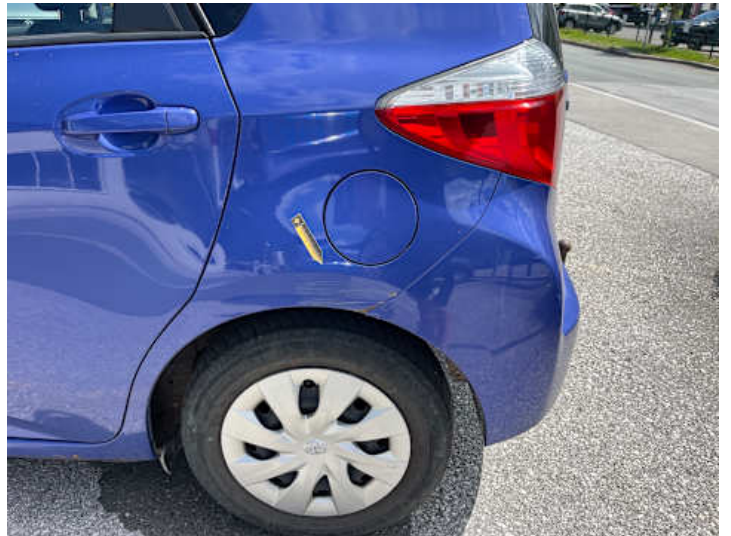
Seitenteil hinten links (Kratzer, Lackschaden, Rost, Delle)
