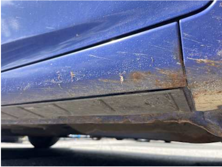
Schweller rechts (Rost, Lackschaden, Verformung)
