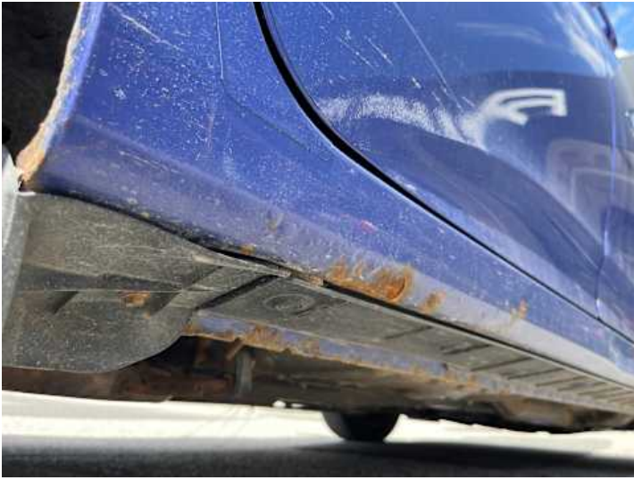
Schweller rechts (Rost, Lackschaden, Verformung)
