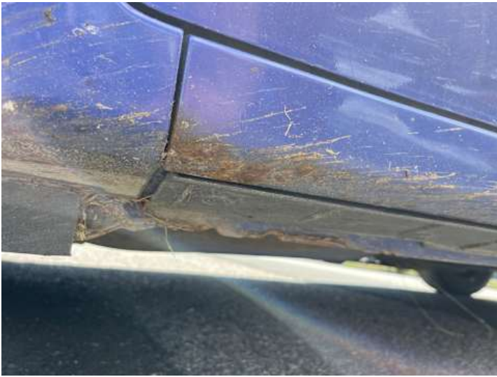
Schweller links (Rost, Lackschaden)
