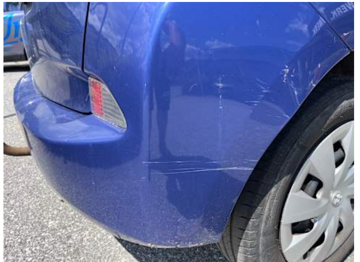
Stoßstange hinten (Kratzer, Lackschaden, Riss/Bruch)
