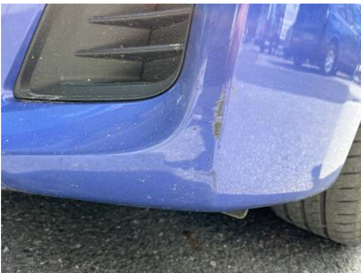
Stoßstange vorne (Kratzer, Lackschaden)
