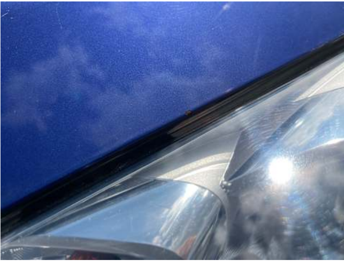
Motorhaube (Steinschlag, Rost)
