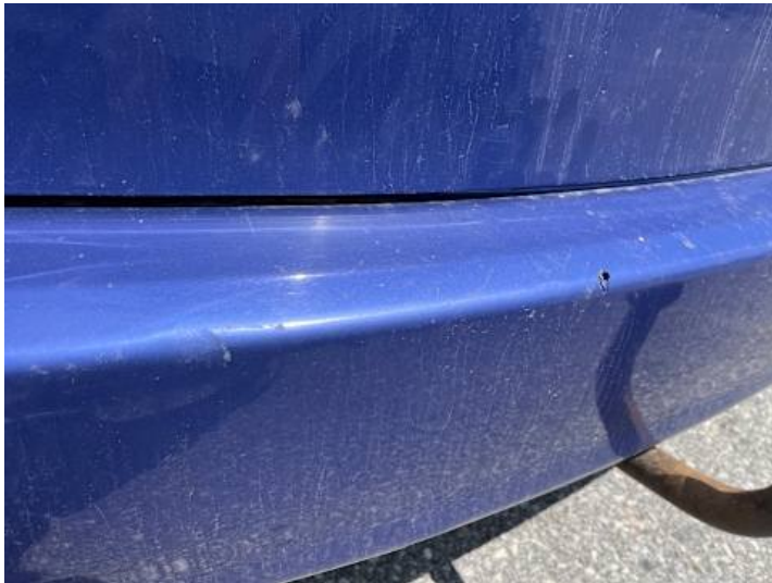
Stoßstange hinten (Kratzer, Lackschaden, Riss/Bruch)
