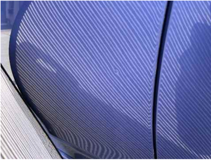
Fahrtür (Delle, Lackschaden)
