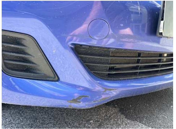
Stoßstange vorne (Kratzer, Lackschaden)
