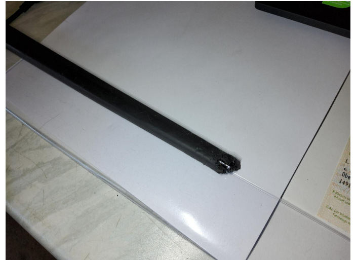
Bild 2: Außen, Dach - Antenne , Tierverschaden, erneuern
