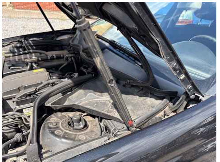
Motorhaube (Anderer Schaden): Haubendämpfer ohne Funktion
