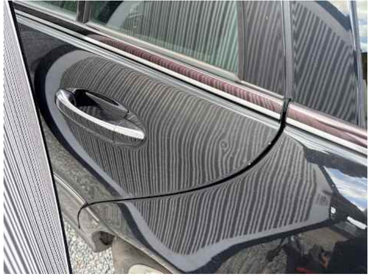
Türe hinten links (Delle)
