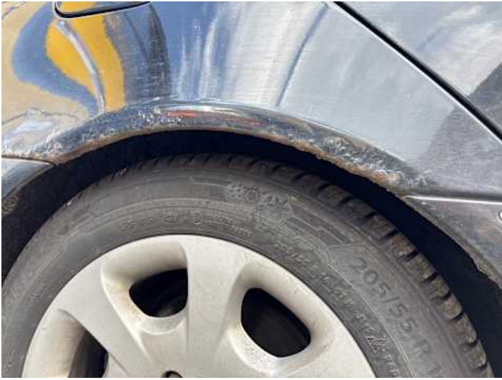
Seitenteil hinten rechts (Lackschaden, Rost)
