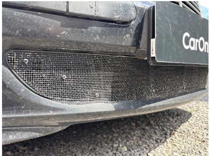
Stoßstange vorne (Unsachgemäß instand gesetzt)
