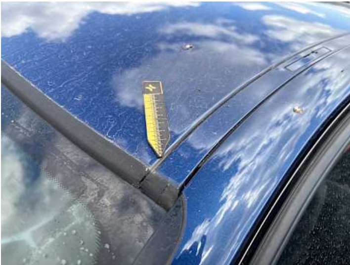
Windschutzscheibe (Anderer Schaden): Dichtung beschädigt
