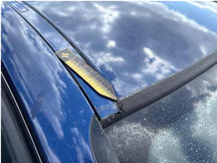
Windschutzscheibe (Anderer Schaden): Dichtung beschädigt
