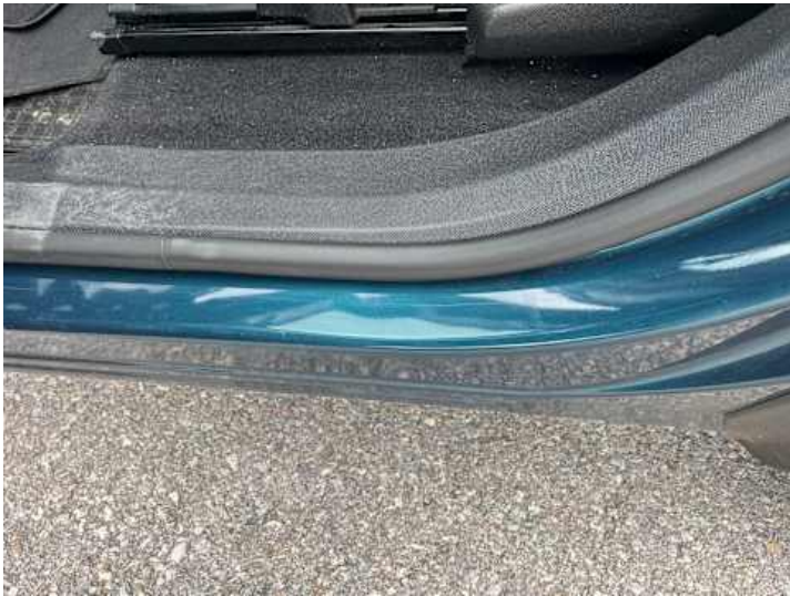
Schweller links (Kratzer)
