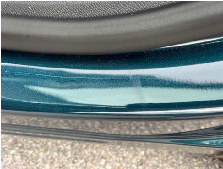
Schweller links (Kratzer)
