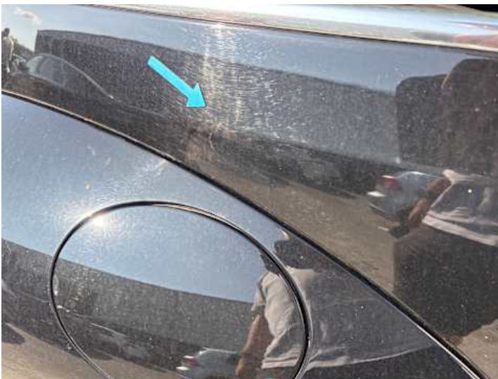
Seitenteil hinten rechts (Kratzer)
