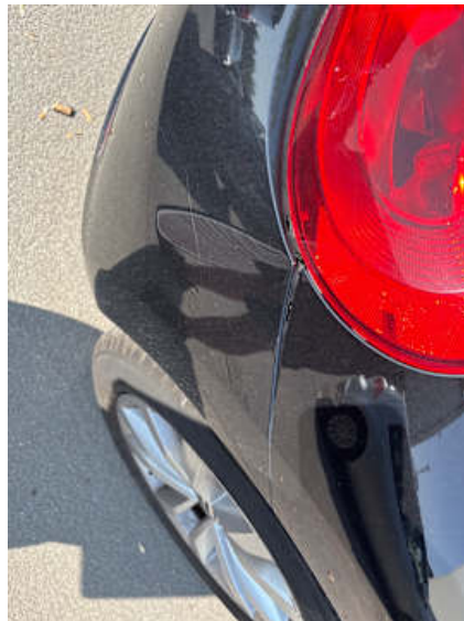
Stoßstange hinten (Spaltmaße ungenau)
