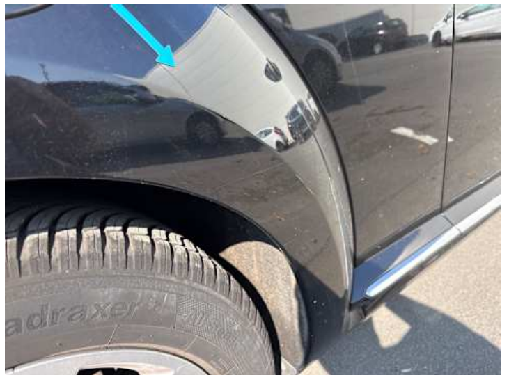
Seitenteil hinten rechts (Kratzer)
